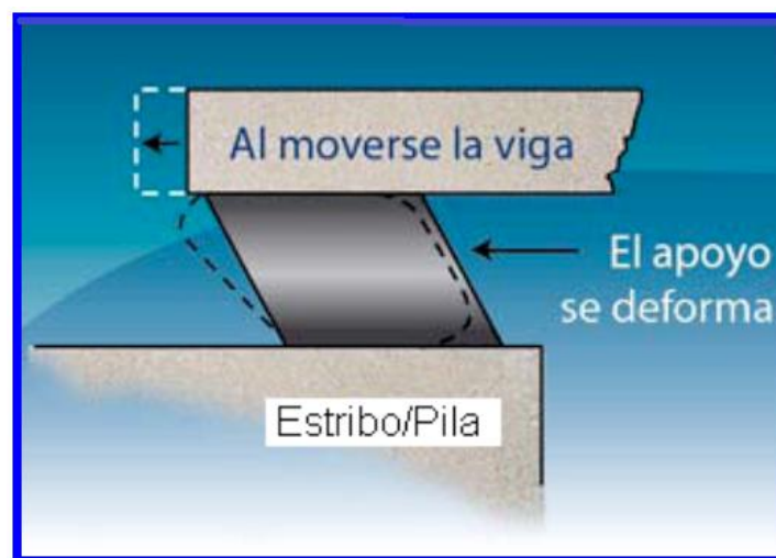
Figura 4.18: Deformación transversal del apoyo
