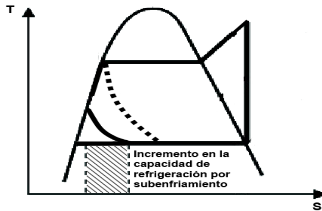
Figura 2.14: Ciclo frigorífico con subenfriamiento.
