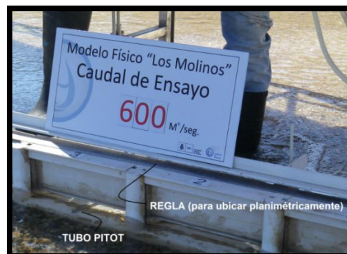
Figura 75: Ubicación del tubo Pitot en la compuerta DM3
