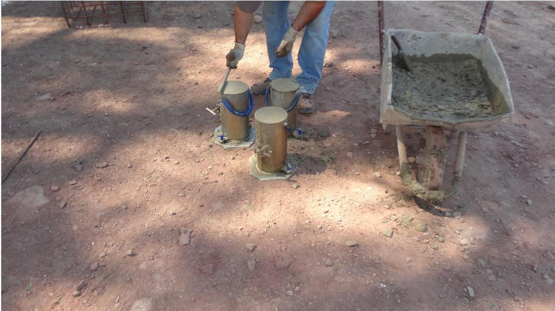
**Figura 5.23:** Elaboración de probetas para ensayo de compresión.
