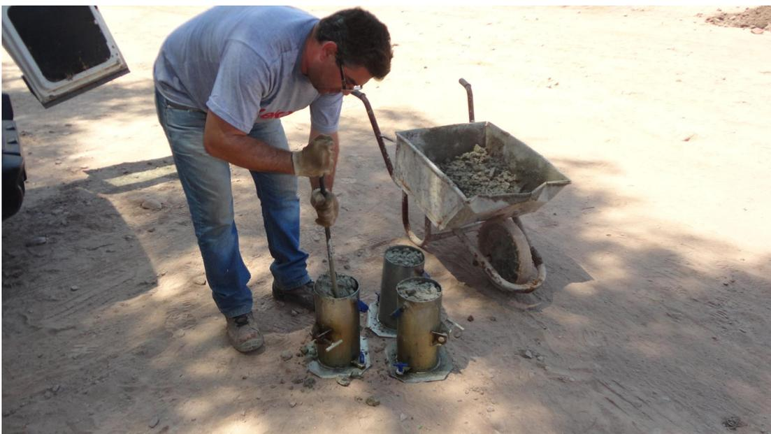
**Figura 5.22:** Elaboración de probetas.
