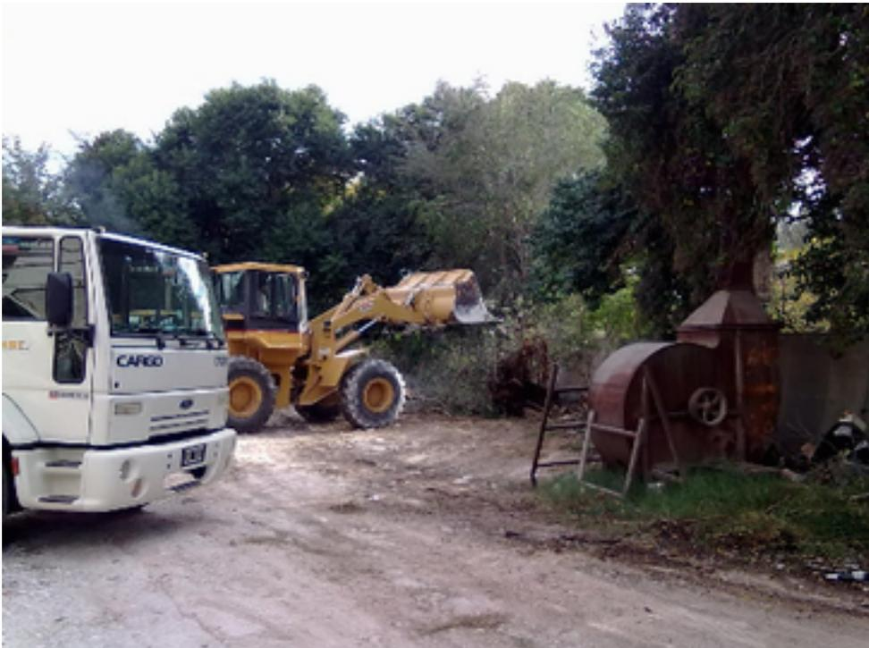
**Figura 4.5:** Pala frontal utilizada para la limpieza del terreno.
