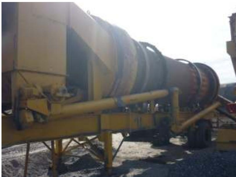
Fig. 3.3 Horno secador de áridos rotativo.
