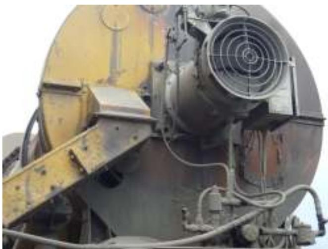
Fig. 3.4 Dispositivo quemador del horno.
