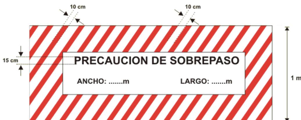
Fig. 3.13 Placa retroreflectiva de precaución y longitudes.
