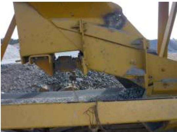
Fig. 3.2 Mecanismo de descarga de fracción 6-19 dotada de sistema vibratorio.
