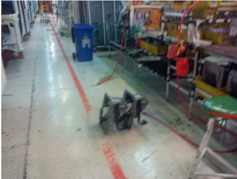
Figura103: Fotografía que muestra el stock intermedio de pedaleras a borde de línea. Fuente: Fotografía de los autores.
