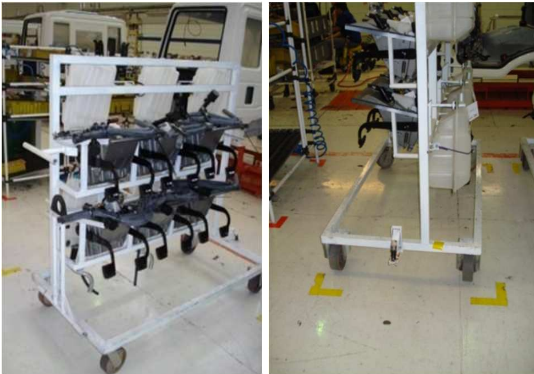
Figura 105: Fotografía de nuevo dispositivo combinado de pedaleras y depósitos. Fuente: Fotografía de los autores.
