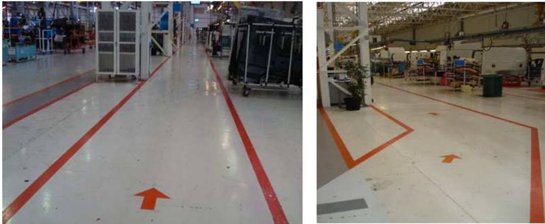
Figura 99: Creación de calle secundaria de abastecimiento más próxima a la línea. Fuente: Fotografía de los autores.
