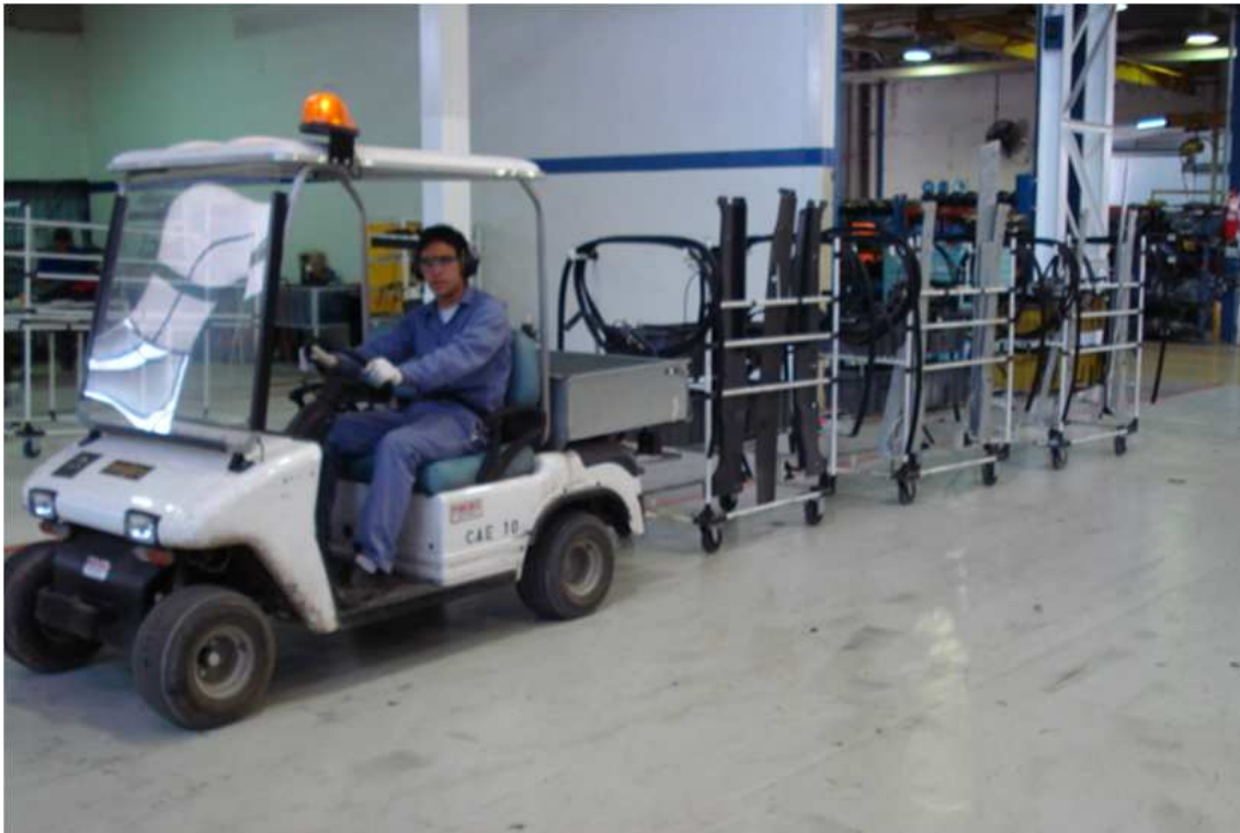
Figura 94: Operador logístico aprovisionando Kit en auto eléctrico. Fuente: Fotografía de los autores.
