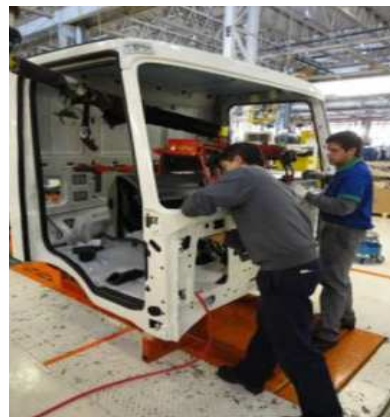
Figura 52: Montaje de Tablero de Instrumentos. Dispositivo Dalmecc. Fuente: Fotografías de los autores.
