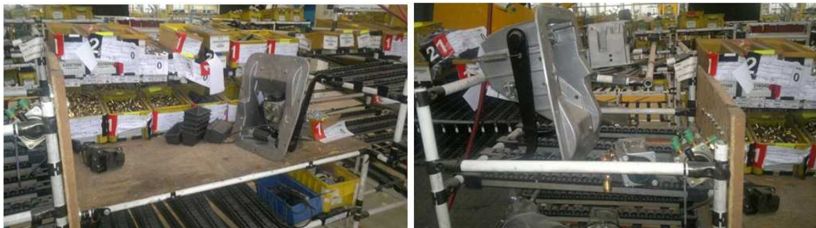
Figura 104: Fotografía de los nuevos bancos de armado de pedalera (de material trilógic). Fuente: Fotografía de los autores.
