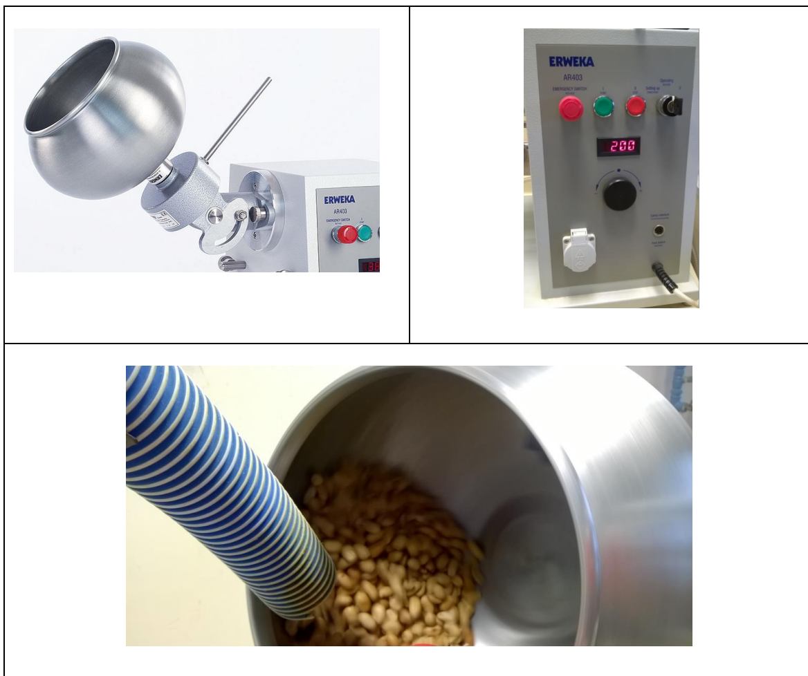
Figura 4.1. Paila rotativa utilizada para el recubrimiento de las muestras de maní tostado.
