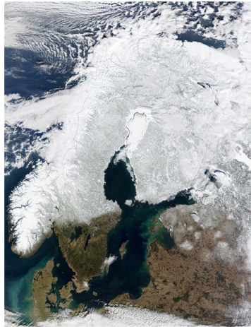
FIGURA 2.2: Ejemplo de una imagen satelital de color real de la región escandinava mostrando nieve el 15 de marzo del 2002, usando las bandas visibles 1,4,3 para RGB de MODIS. http://modis.gsfc.nasa.gov/
