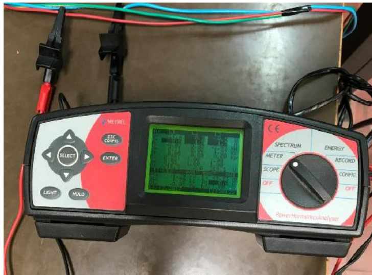
Figura A.IV.1: Fotografía de Analizador de armónicos Metrel MI 2092.
