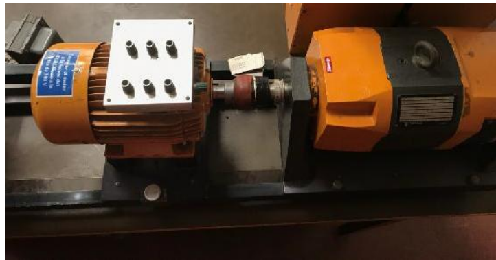
Figura 5.2: Fotografía de generador utilizado como carga del motor.
