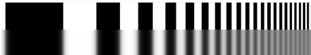
Fig. 4.2.17 Patrón de barras. La parte superior es nítida y la inferior no lo es (47) .
