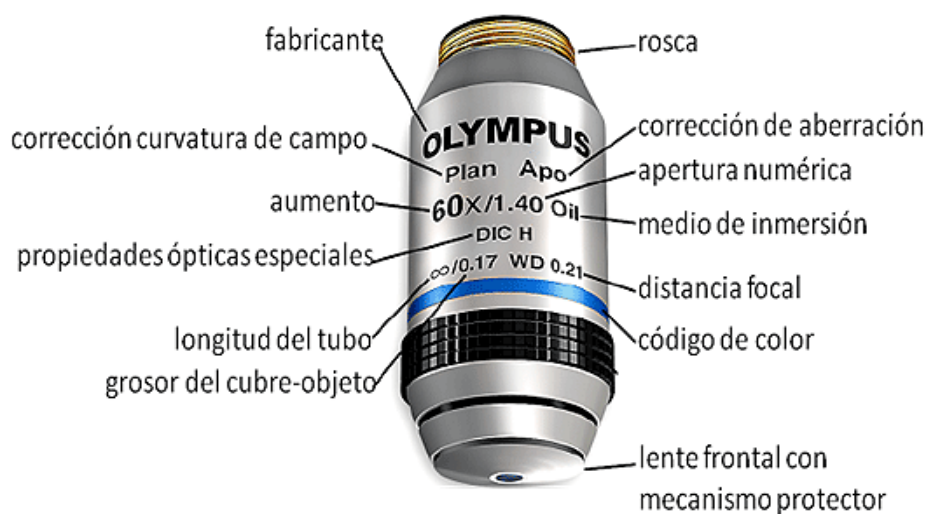
Fig. 3.2.29 Fotografía de un objetivo comercial (25) .
