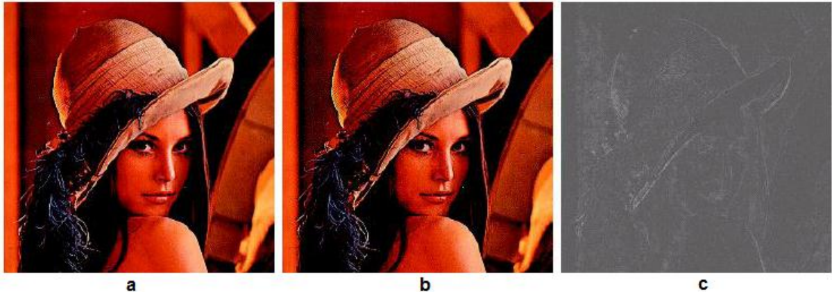
Fig. 3.3.35 Aplicación del laplaciano. (a) En cada componente de la imagen RGB. (b) En el componente intensidad del espacio HSI. (c) Diferencia entre los dos resultados (35) .
