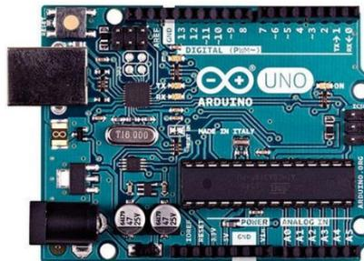
Ilustración 22: Microcontrolador Arduino UNO
