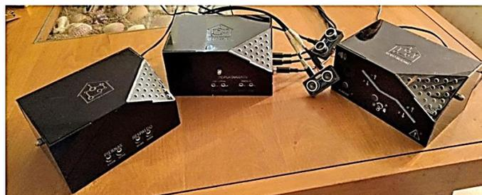
Ilustración 49: Componentes físicos involucrados: A la izquierda el nodo que controla la Camilla. En el centro el nodo que controla el Arnés. A la derecha el nodo Maestro
