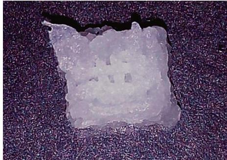
Figura 9. Vista superior de un andamio impreso, observándose el entramado de las capas impresas.
