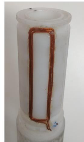
Figura 3.10: Fotografía del acople inductivo fabricado. El resonador *birdcage* se encuentra en el interior. La apertura angular sostenida por el ancho de la bobina de acople con respecto al eje del cilindro coincide con la apertura angular de 2 patas contiguas del resonador.
