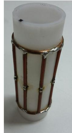
Figura 3.8: Fotografía de la bobina *birdcage* fabricada para la sonda de RF de nuestro prototipo IRM+CR.
