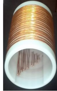
Figura 2.8: Foto de la bobina de corrientes múltiples fabricada. Las conexiones entre los distintos pares anti-Helmholtz se muestran en la cara interna del soporte cilíndrico. Se realizaron dichas conexiones utilizando dos conductores que portan igual corriente en sentido opuesto. El objetivo de tal arreglo es minimizar la producción de componentes de campo magnético transversal al eje de la bobina.
