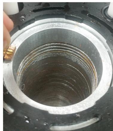
Figura 4.1: Fotografía del electroimán principal durante el desmontaje del equipo. Se muestra la separación entre espiras del helicoide que deberían permanecer unidas por pegamento epoxi (*Poxy-pol*).
