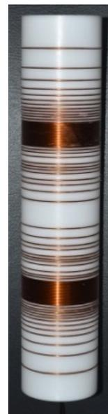
Figura 2.6: Fotografía de la bobina de gradiente longitudinal fabricada para la unidad de gradientes de nuestro prototipo IRM+CRC. El diámetro del bobinado es de  $50 \text{ mm}$  y su longitud es de  $184 \text{ mm}$ .
