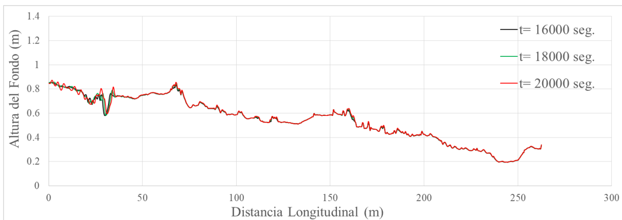
FIGURA 3. 37. PROYECCIÓN DE UN CORTE LONGITUDINAL DE LA MORFOLOGÍA FLUVIAL DEL RÍO TERCERO PARA JUSTIFICAR EL RÉGIMEN DE LAS FORMAS DE FONDO, Q=18.89 \text{ m}^3/\text{s} .
