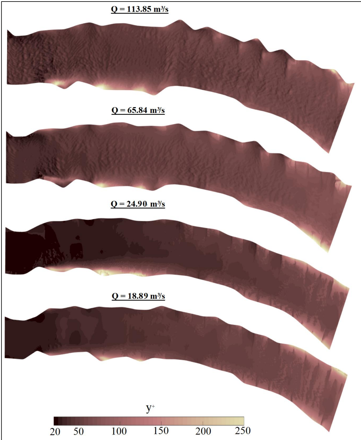
FIGURA 3. 13. ESQUEMA DE ÁREAS COLOREADAS QUE REPRESENTAN LA VARIABLE y^+ DE LA SIMULACIÓN DEL FLUJO DEL RÍO TERCERO AGUAS ABAJO DEL PUENTE JUAN BAUTISTA ALBERDI.
