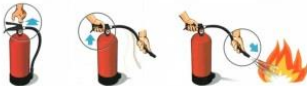
Ilustración 7: Manejo de extintor
