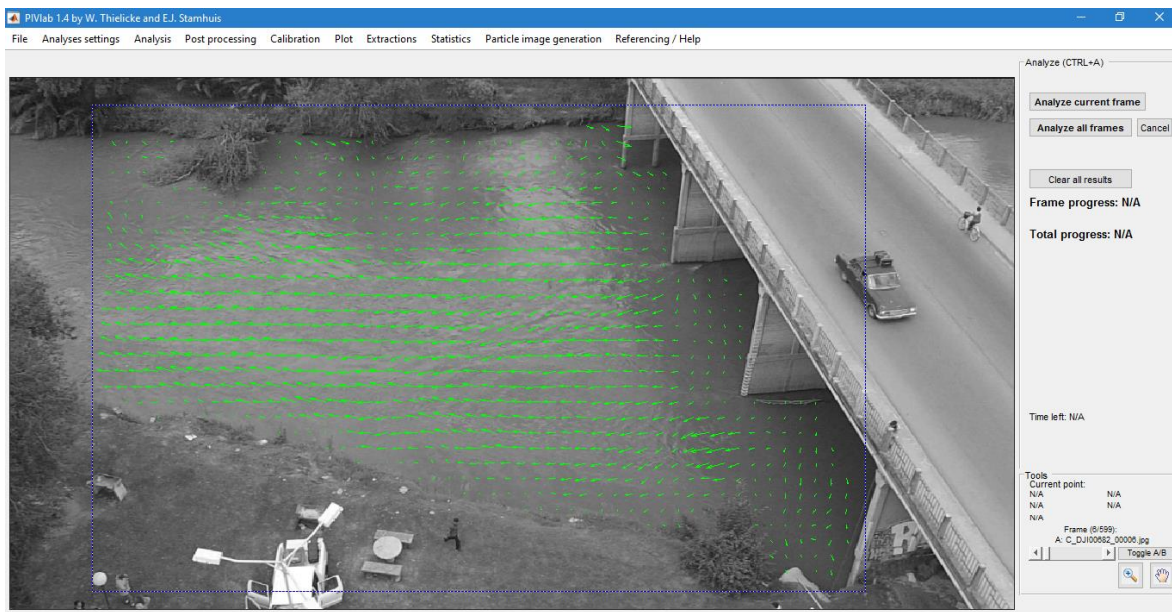
Figura A. 19: Panel desplegado al clicar “Analyse!”, donde se encuentra la opción “Analyze current frame”.
