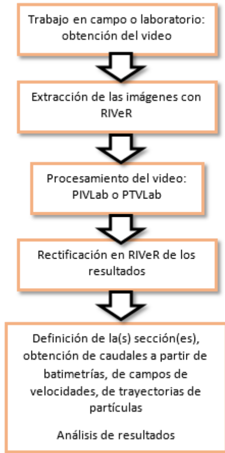
Figura 1. 2: Esquema de la metodología de trabajo para LSPIV y LSPTV.
