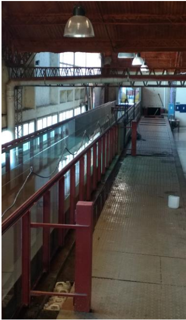
Figura 4. 2: Canal empleado en el testeo de configuraciones y aplicación de las técnicas de medición.
