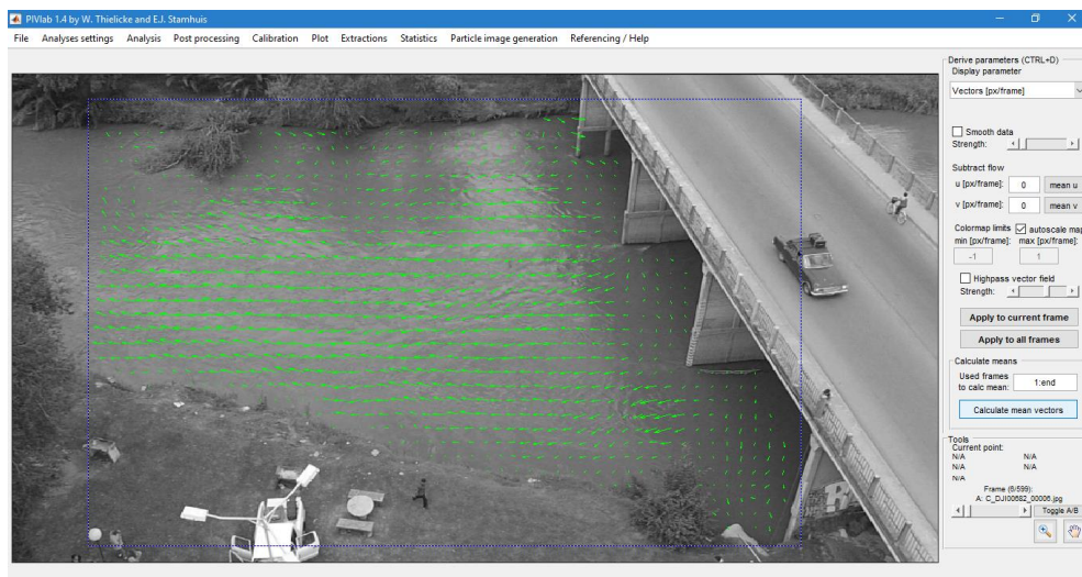
Figura A. 20: Imagen del campo de velocidad finalizado el procesamiento.
