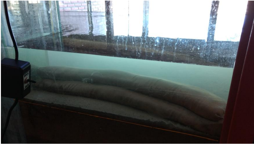
Figura 4. 4: Configuración adoptada con condición de 2 seditubos (G2).
