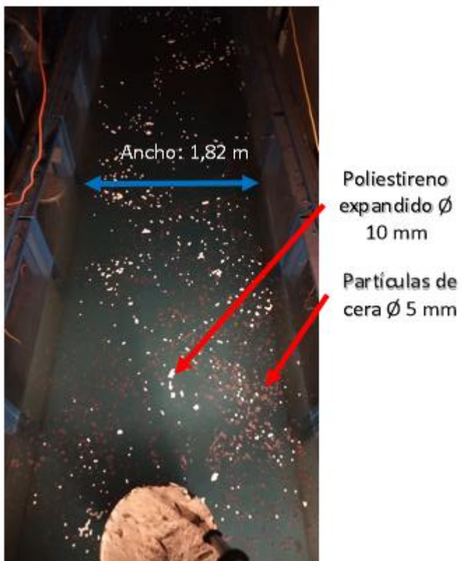
Figura 2. 2: Imagen no rectificada de la pila dentro del canal con las diferentes partículas sembradas.
