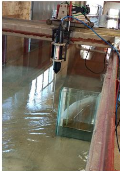
Figura 4. 3: Configuración adoptada con condición de 5 seditubos (G5). Imagen izquierda: vista desde aguas arriba. Imagen derecha: vista desde aguas abajo.
