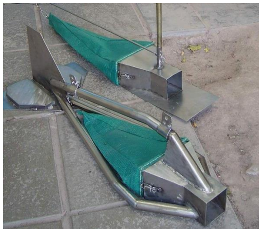
Figura 38.- Trampa de sedimentos de fondo Helley-Smith. Arriba para estiaje y abajo para crecida
