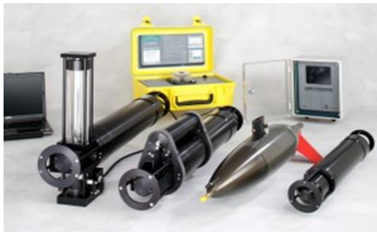
Figura 16.- Estimador de sedimentos por difracción láser (LISST) (de Sequoia Scientific Inc.: http://www.sequiasci.com/ )
