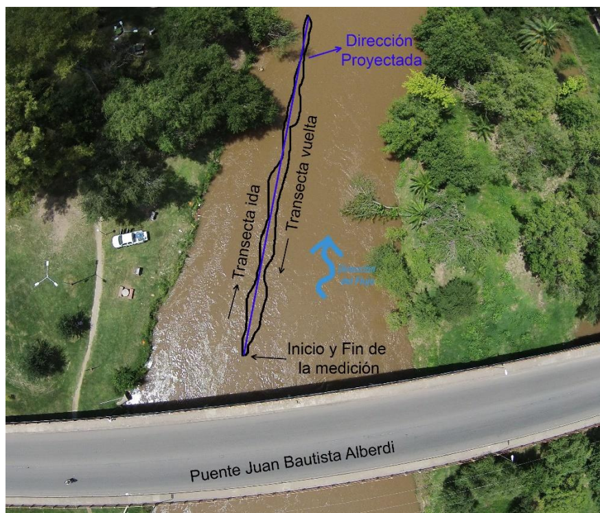
Figura 43.- Proyección de las mediciones longitudinales con ADCP
