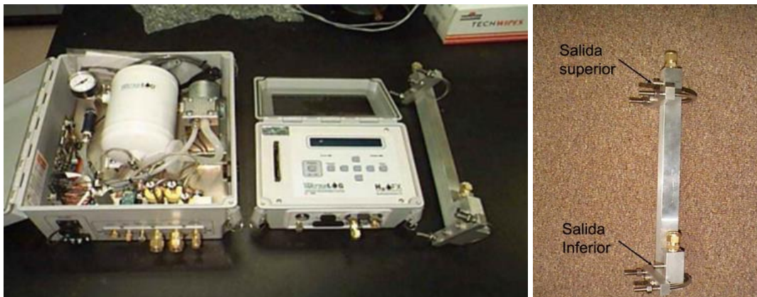
Figura 19.- Estimador de sedimentos en suspensión por diferencia de presiones (Gray, 2012)
