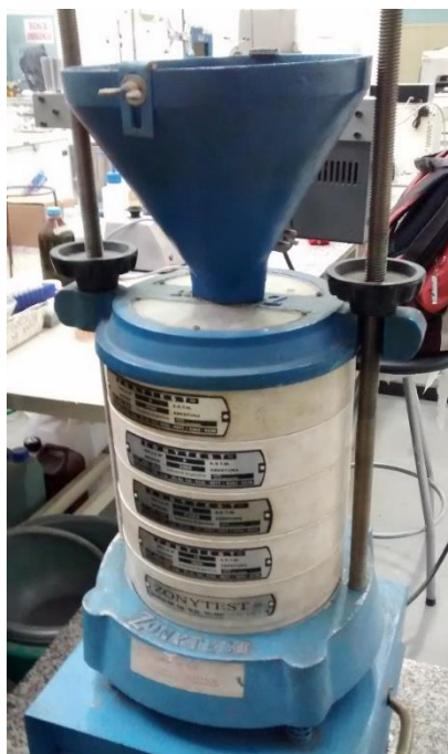
Figura 25. Tamiz Zonytest utilizado para determinación de granulometría.
