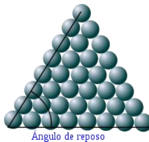
Figura 51. Ángulo de deslizamiento, de talud o de reposo de un material,
