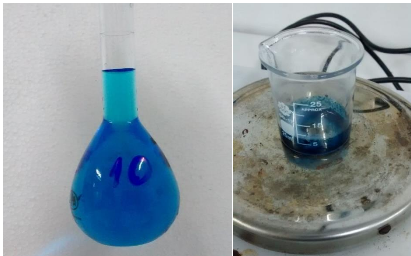
Figura 34. Solución de azul de metileno, 10 mg/L.- Agitación magnética de solución de azul de metileno y carbón
