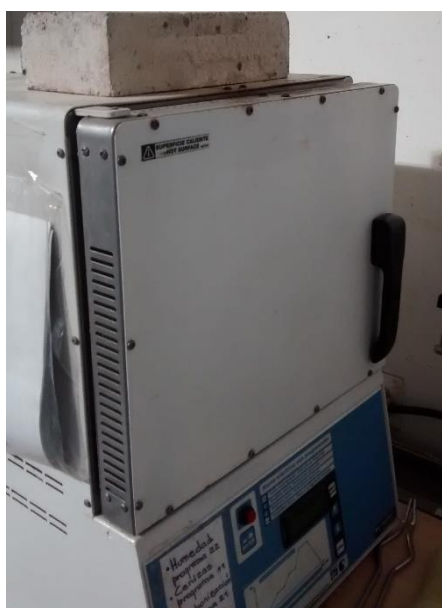
Figura 26. Mufla utilizada para determinación de velocidad de carbonización.
