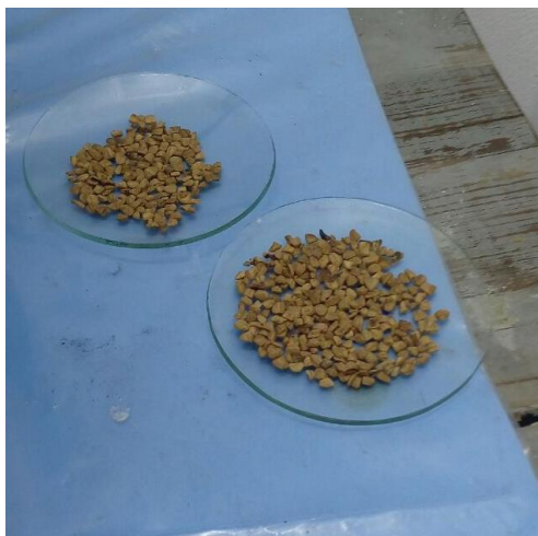
Figura 23. Muestras de trozos de carozos previo al secado para determinación de humedad.
