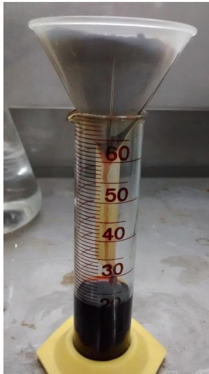
Figura 32. Filtración de mezcla de carbón activado y solución de yodo.
