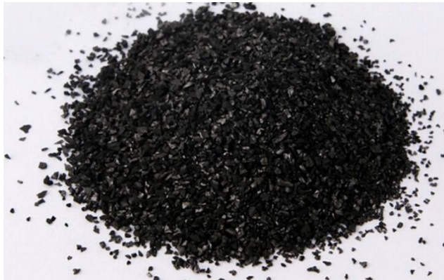
Figura 2. Carbón activado granular.
