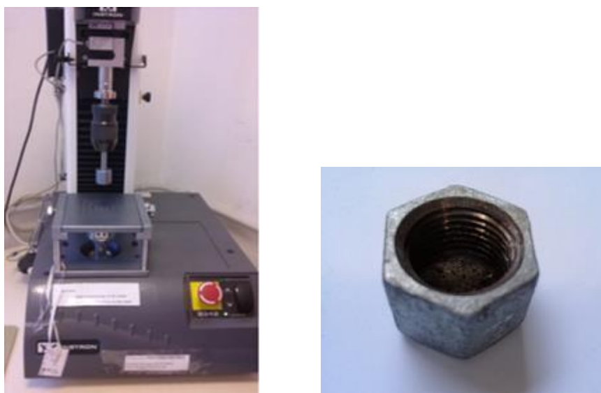
Figura 35. Imagen de texturómetro (Universal Testing Machine modelo 3342, Instron, EUA) y de tapón metálico adaptado.
