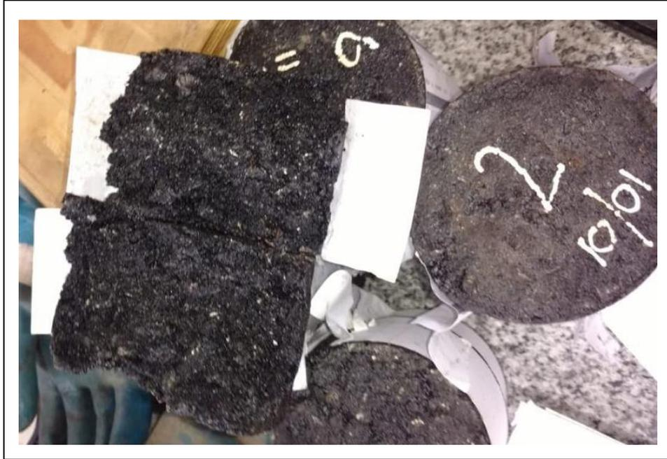
*Figura 5.4: Probetas moldeadas y numeradas para ser ensayadas por el Método de Marshall*
