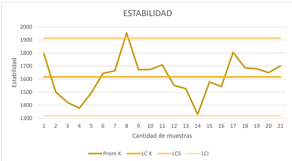
Figura 5.18: Gráfico de control de Estabilidad de mezclas elaboradas con asfalto de tipo modificado AM3
