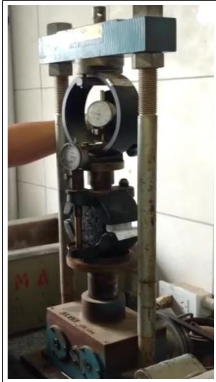
*Figura 5.5: Ensayo de Estabilidad y Fluencia realizado en Laboratorio de la empresa Afema S.A.*
