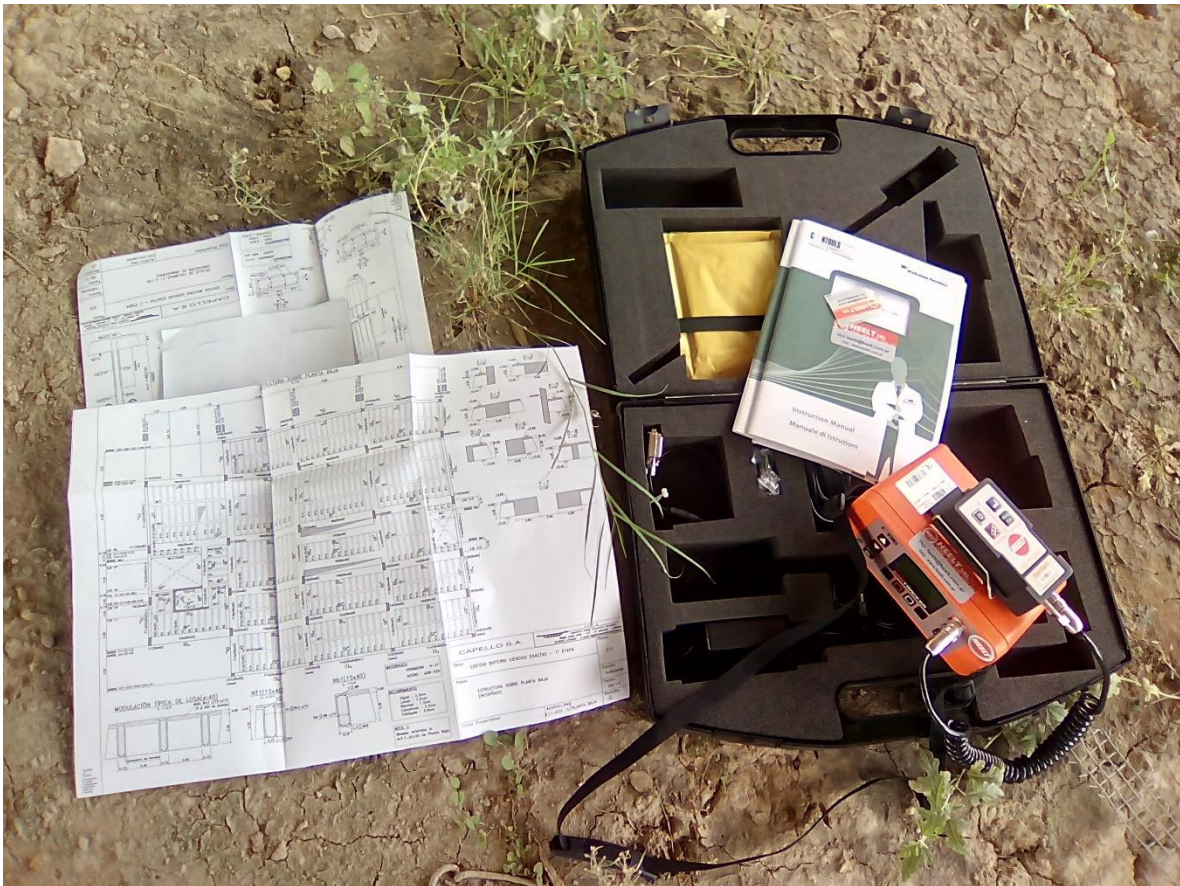
Figura 13. Localizador de armadura – Visita Técnica
