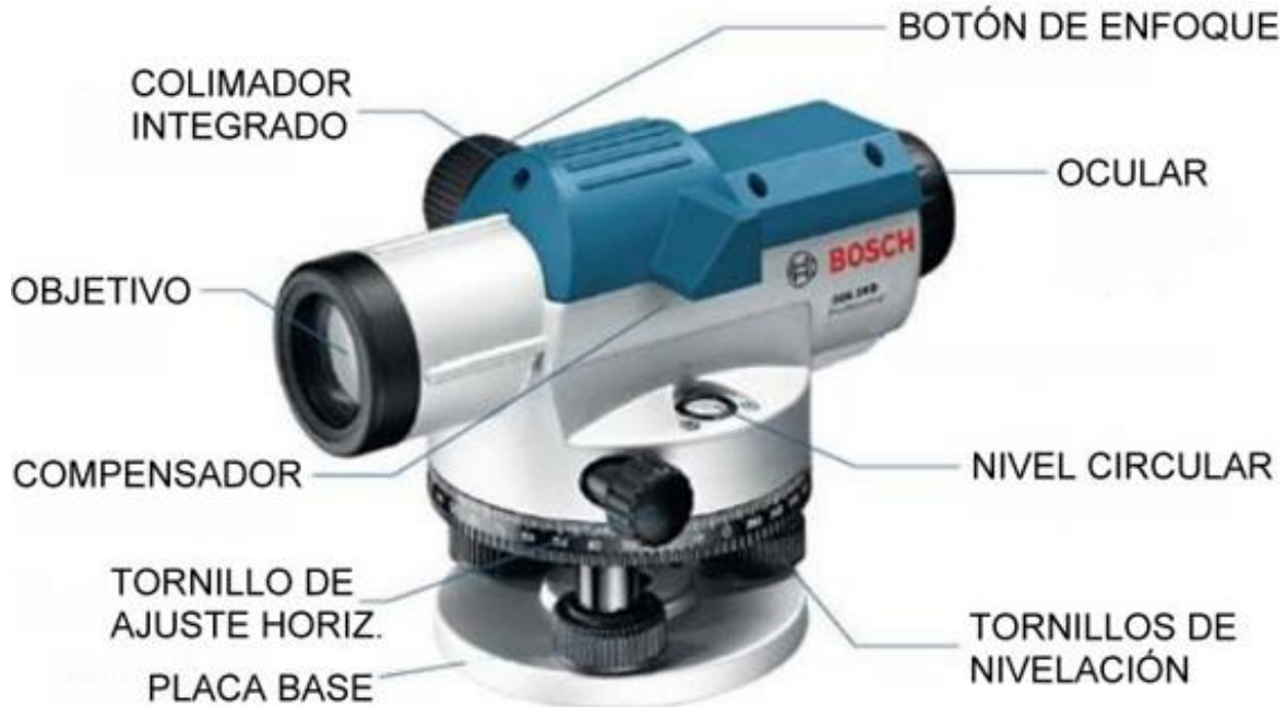
Figura 17. Partes de un nivel óptico automático.
