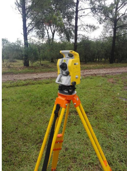
Ilustración 3: Estación Trimble M3 Utilizada
