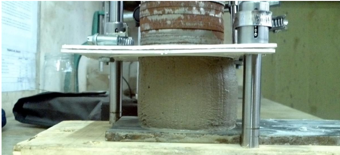
Figura 4.11 -Probeta de mortero fresco bajo carga en ensayo de compresión
