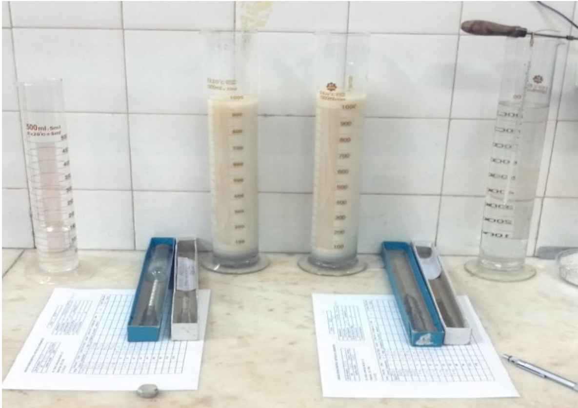
Figura 3.6 - Método del hidrómetro, Laboratorio de suelos
