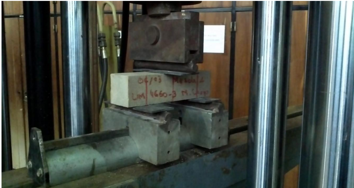
Figura 4.5 - Probeta prismática Lista para ensayo de tracción por flexión, Norma IRAM 1622
