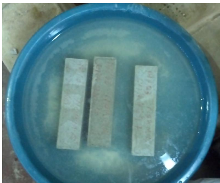
Figura 4.4 - Izquierda: Probetas en molde luego de la preparación. Derecha: probetas en recipiente para curado.
