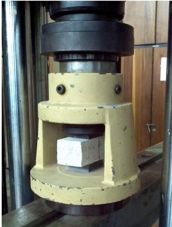
Figura 4.7 - Mitad de probeta prismática lista para ensayo de compresión
