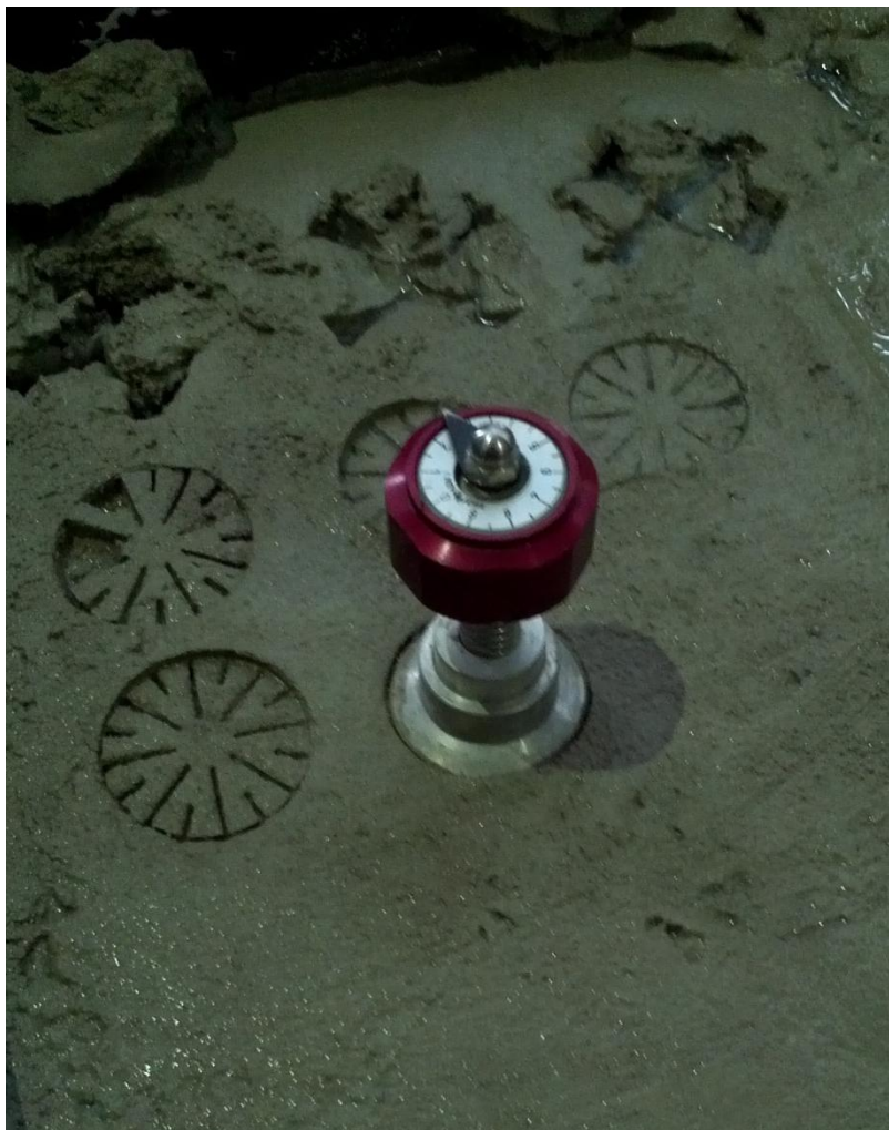
Figura 4.2 - Ensayo de corte sobre mezcla de partida
