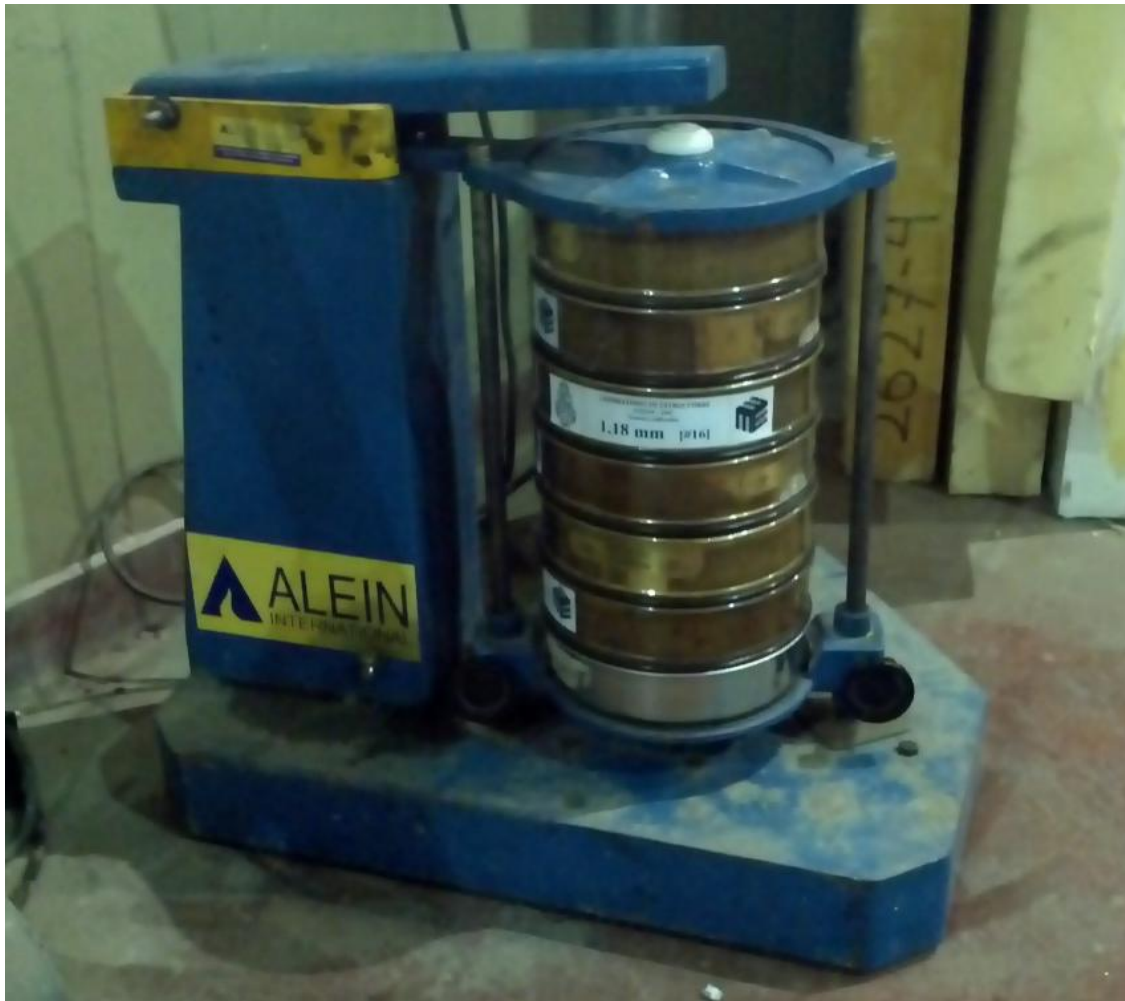
Figura 3.2 - Tamizadora mecánica, laboratorio de estructuras
