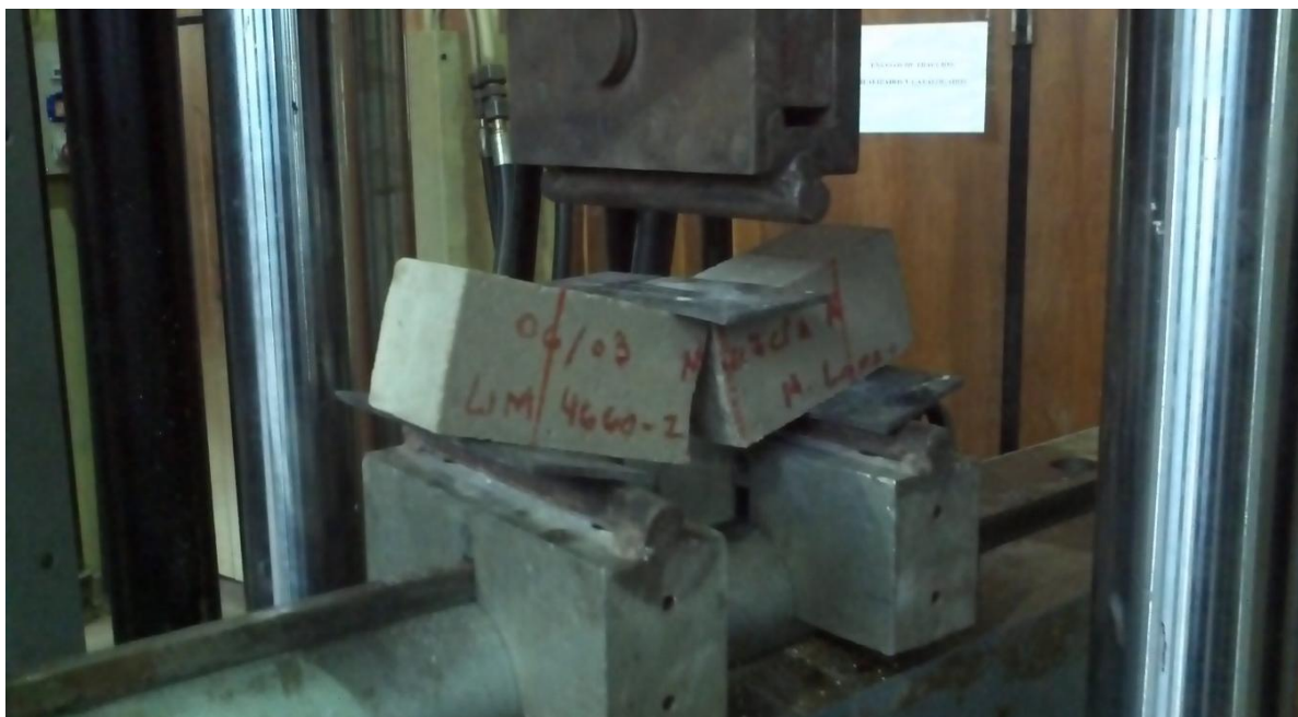
Figura 4.6 - Rotura de probeta prismática en ensayo de tracción por flexión, Norma IRAM 1622
