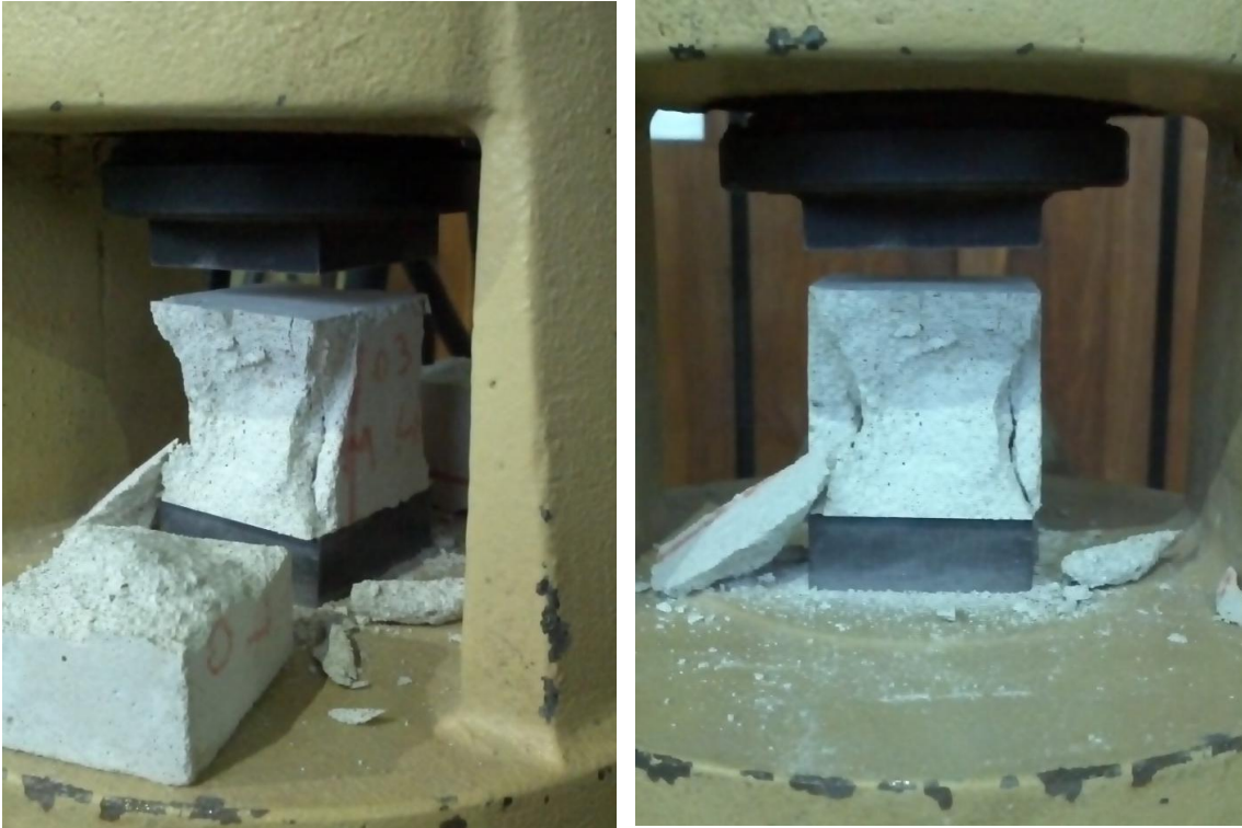
Figura 4.8 - Rotura a compresión de probeta prismática
