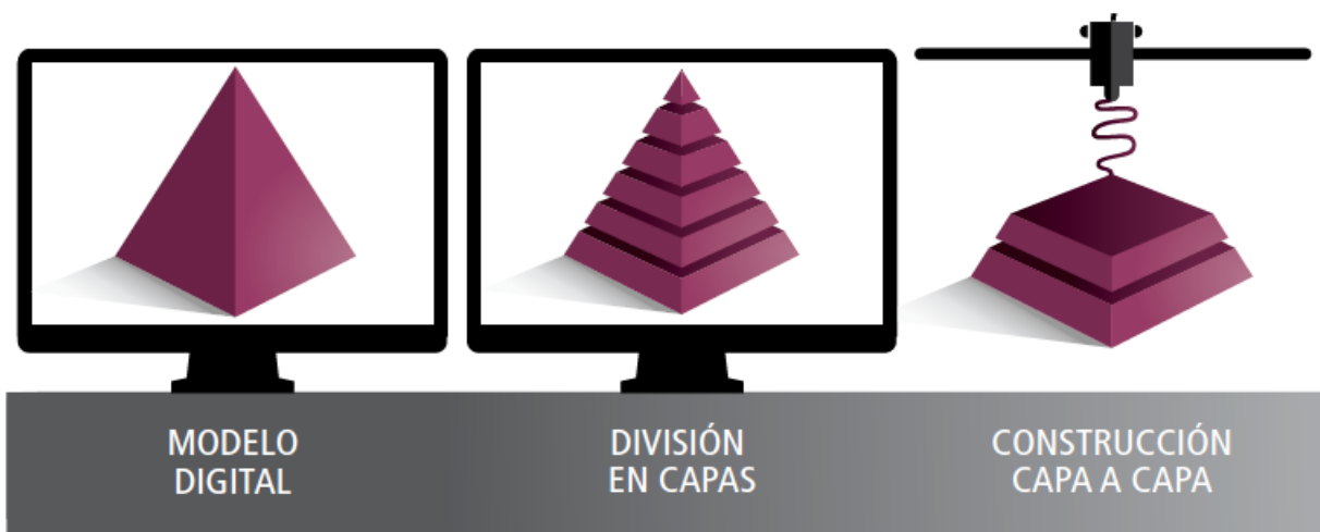
Figura 2.1 - Figura Ilustración del proceso – Fuente: Manual Básico FDM I3D, INTI Diseño industrial
