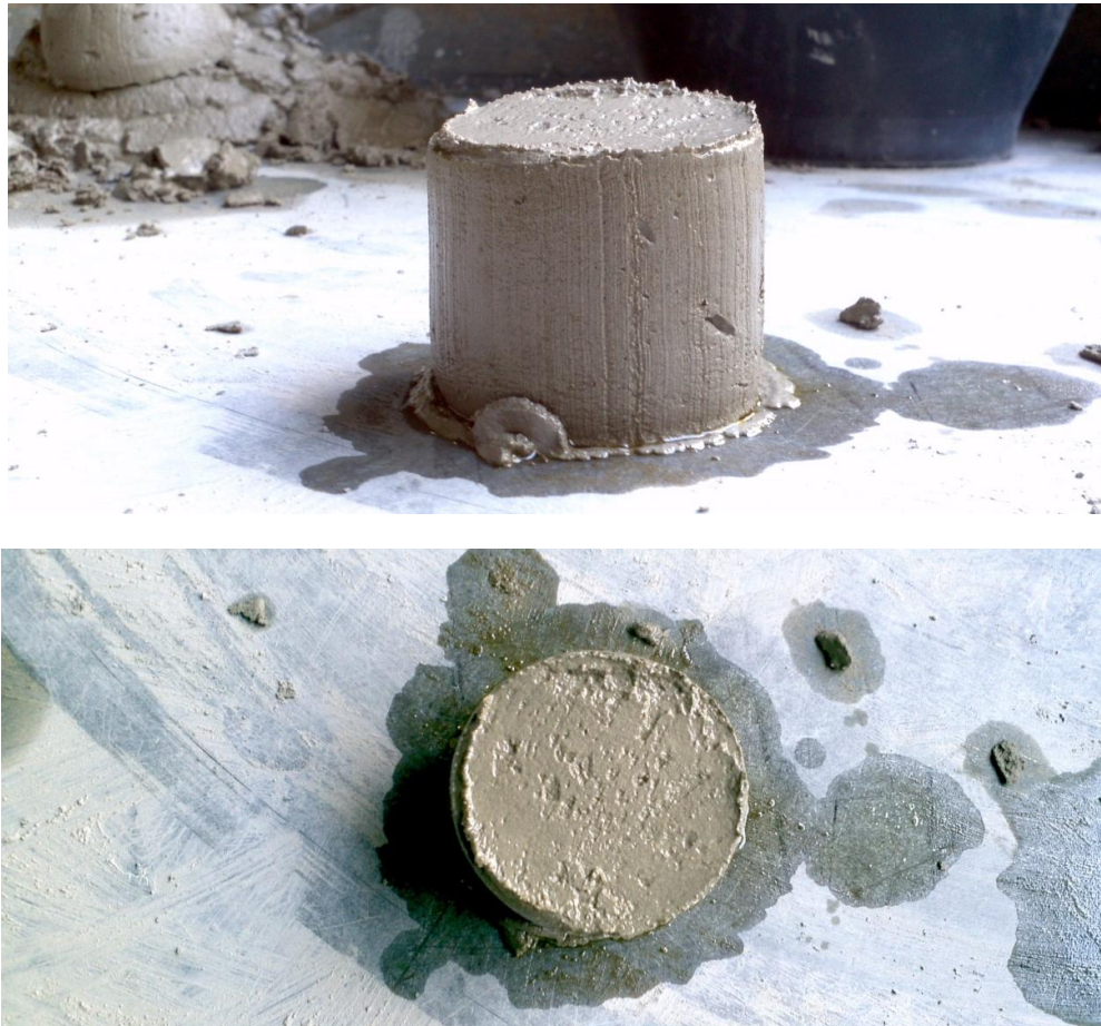
Figura 4.9 - Probeta de mortero en estado fresco
