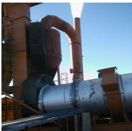
Figura 2.3: Componentes de la Planta de Asfalto - a) Tolvas b) Cinta Transportadora y quemador c) Tambor secador Mezclador d) Tolva de descarga
