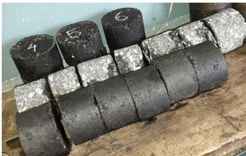
Figura 6.41: Probetas de Asfalto a ensayar y Testigos de la Carpeta de Rodamiento
