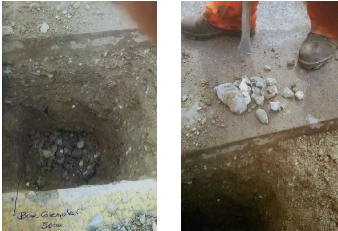
Figura 1.5: a) Base Granular de 50 cm de espesor; b) Pasante Retenido Tamiz 1"
