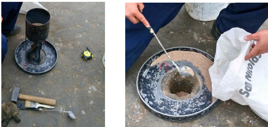
Figura 6.26: Ensayo de Cono de Arena - a) Medición del Volumen con Arena, b) Recuperación de la Arena Normalizada
