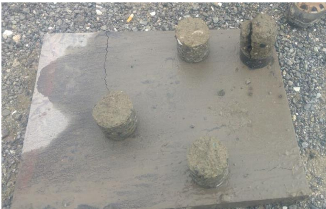
Figura 6.48: Ejecución del Dren- a) Limpieza de la superficie aserrada, b) extracción de testigos Base, c) testigos del pavimento, d) Testigo con fisuras en suelo cemento
