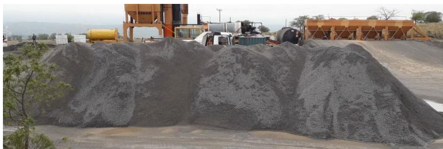
Figura 2.4: Arena de Trituración tipo 0-6
