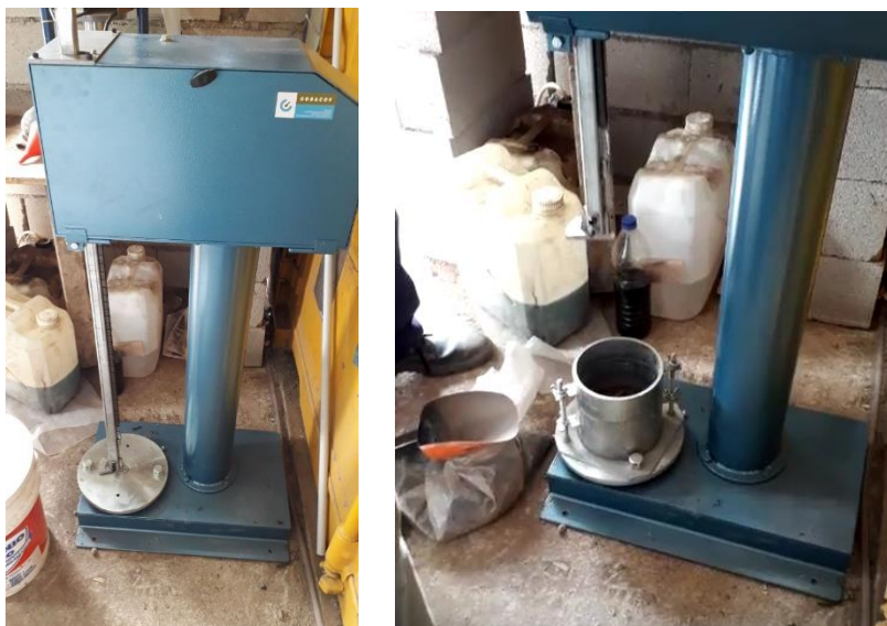
Figura 6.24: Ensayo Proctor, a) Pisón de Compactación de Suelo y b) Molde Normalizado
