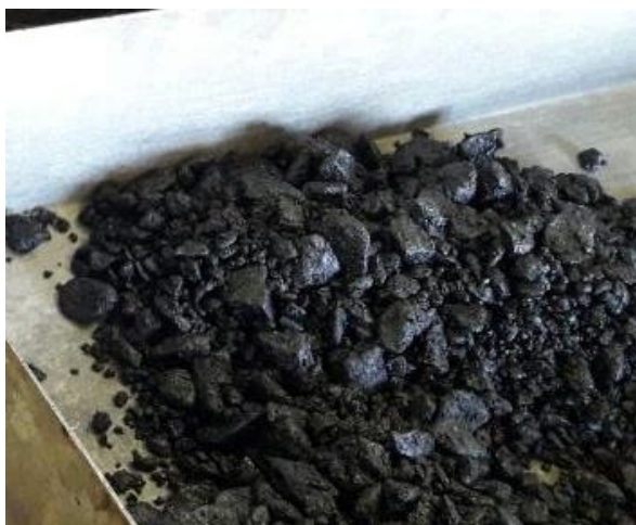
Figura 6.37: Ensayo de Composición de la mezcla- a) Muestra extraída de planta, b) Centrifuga
