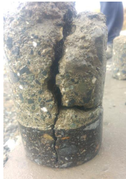
Figura 6.48: Ejecución del Dren- a) Limpieza de la superficie aserrada, b) extracción de testigos Base, c) testigos del pavimento, d) Testigo con fisuras en suelo cemento
