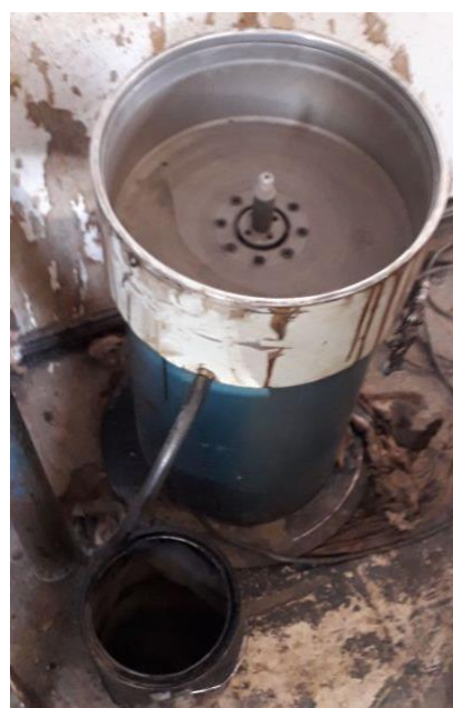
Figura 6.37: Ensayo de Composición de la mezcla- a) Muestra extraída de planta, b) Centrifuga
