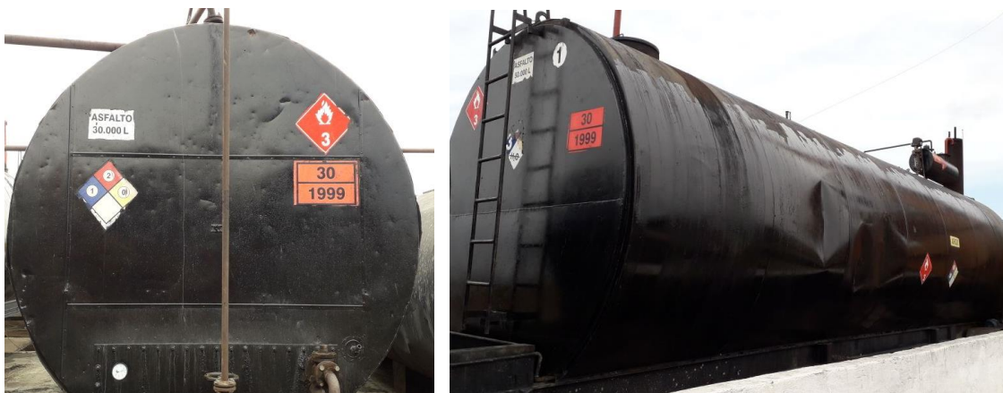
Figura 2.7: Tanques de Asfalto a) 30.000 lts b) 50.000 lts
