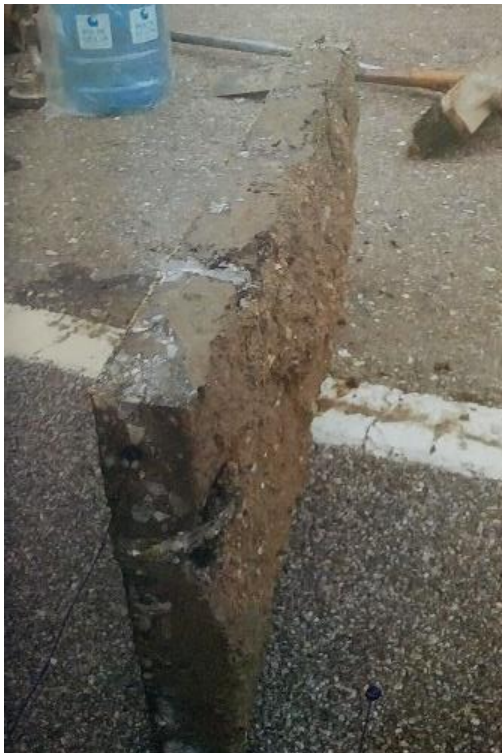
Figura 1.4: a) Concreto Asfáltico de 6 cm de espesor; b) extracción de material de Muestra para laboratorio
