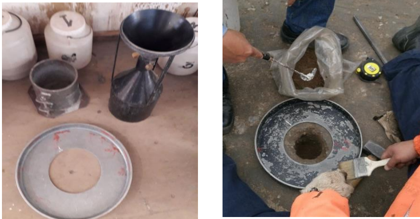
Figura 6.25: Ensayo de Cono de Arena- a) Instrumentos del ensayo, b) Extracción del Material Base
