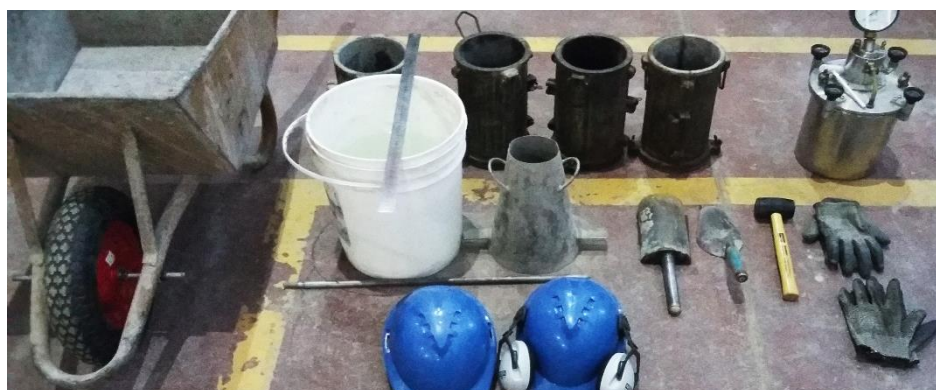
Fig. 3.10 Elementos necesarios para realizar los ensayos en estado fresco y moldeado de probetas
