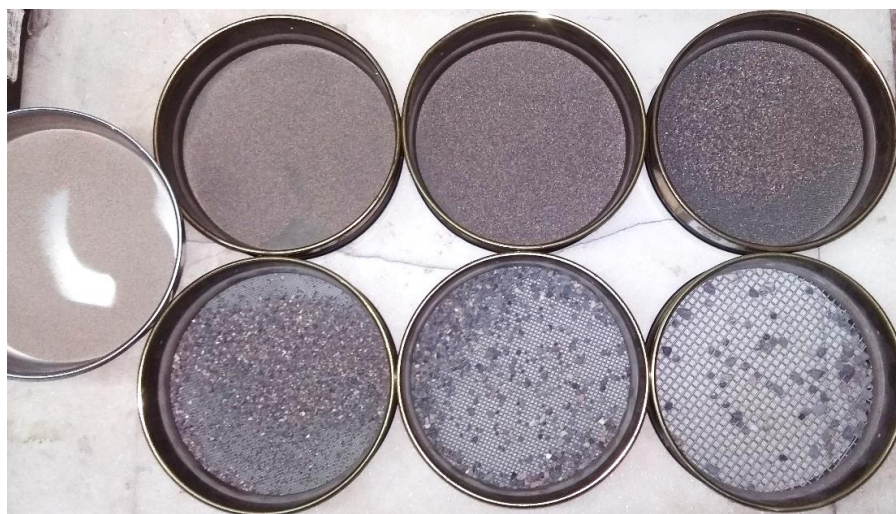
Fig. 3.4 Resultado del tamizado por vibrado mecánico del agregado fino
