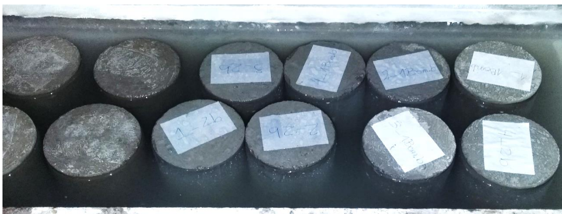
Fig. 3.12 Probetas identificadas y sumergidas en cámara de curado
