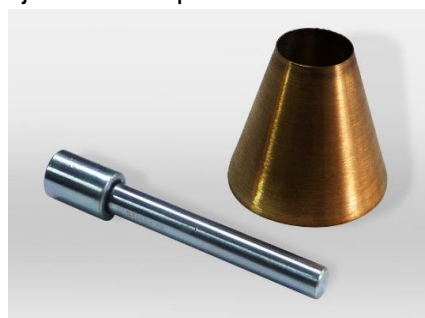
Fig. 3.6 Tronco cono y pisón de compactación para determinación de estado saturado superficie seca
