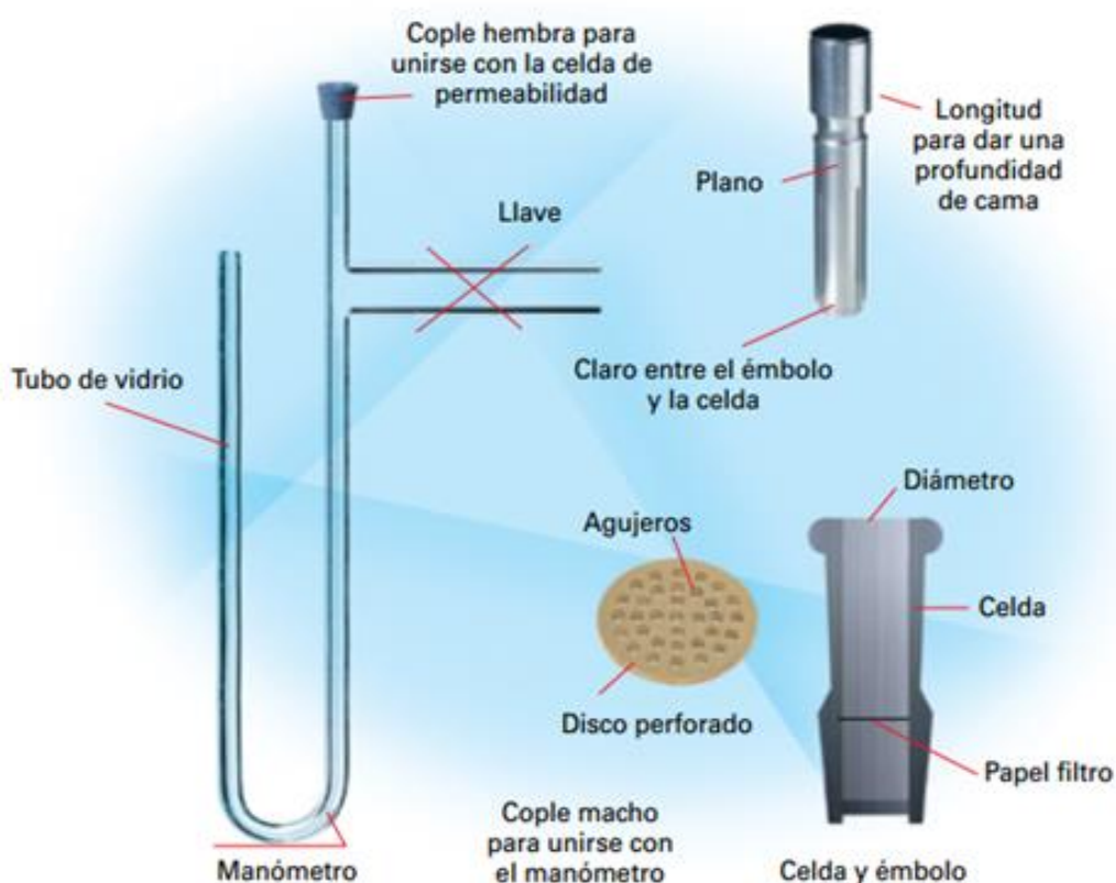
Fig. 1.6 Instrumental necesario para ensayo de permeabilidad de Blaine
