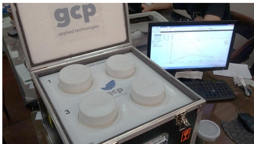
Fig. 2.10 Lecturas en software HOBOWare del Calorímetro Semiadiabático
