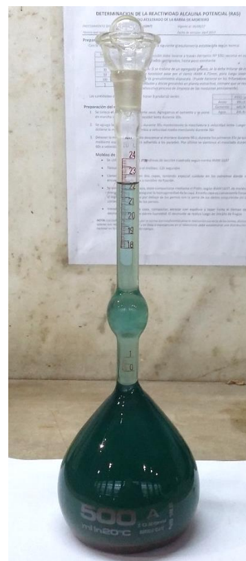
Fig. 1.5 Le Chatelier más cemento después del reposo.
