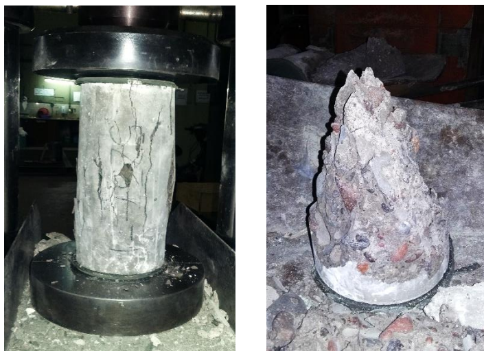
Fig. 3.13 A la izquierda, la probeta alcanzó la rotura; a la derecha se evidencia el tipo de falla TIPO 1
