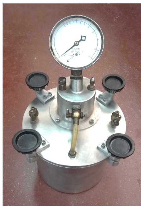
Fig. 4.2 Aparato de Washington calibrado para ser usado
