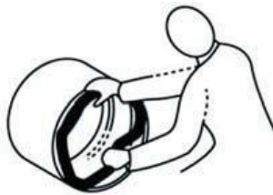
Imagen N° 7.20: Instalación de los empaques de sello
