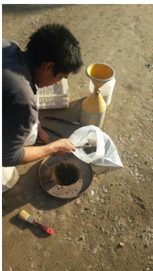
Imagen Nº 7.35: Ensayo de compactación.
