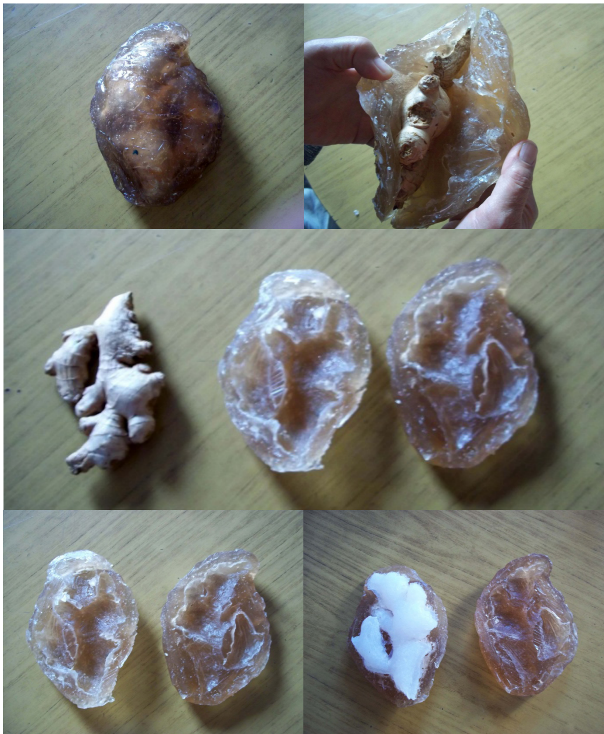
[Figura 35] Proceso de fabricación de moldes a partir de jengibre.
