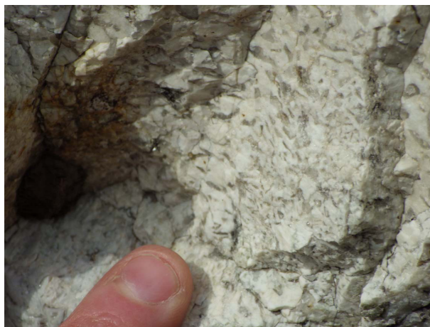
[Figura 23] Textura en rocas plutónicas, textura gráfica o pegmatítica (cristalización simultánea de cuarzo y feldespatos potásico).
