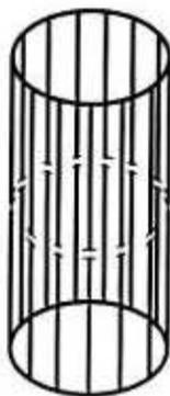
**Figura 3.2:** Esquema de la bobina tipo birdcage utilizada.
