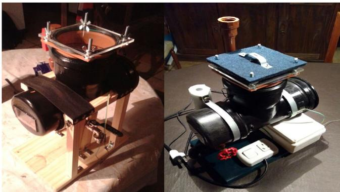
Fig. 3. Primer prototipo de celda electrolítica vs Celda electrolítica final, en vista perspectiva frontal.
