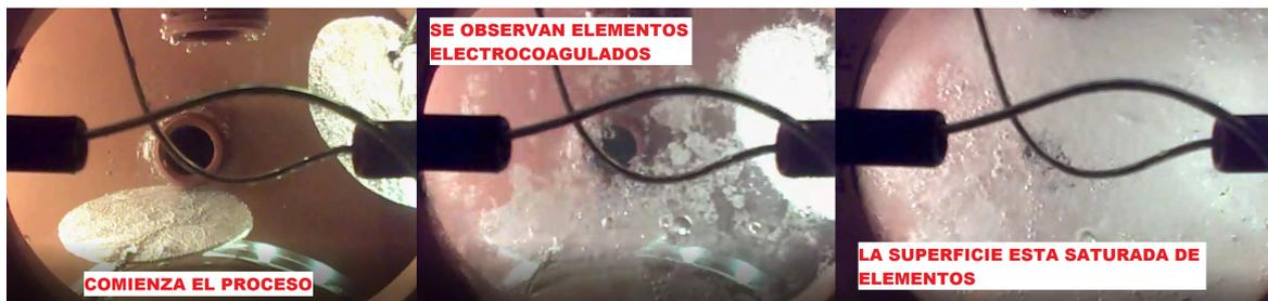
Fig. 10.29 Etapas de la electrocoagulación
