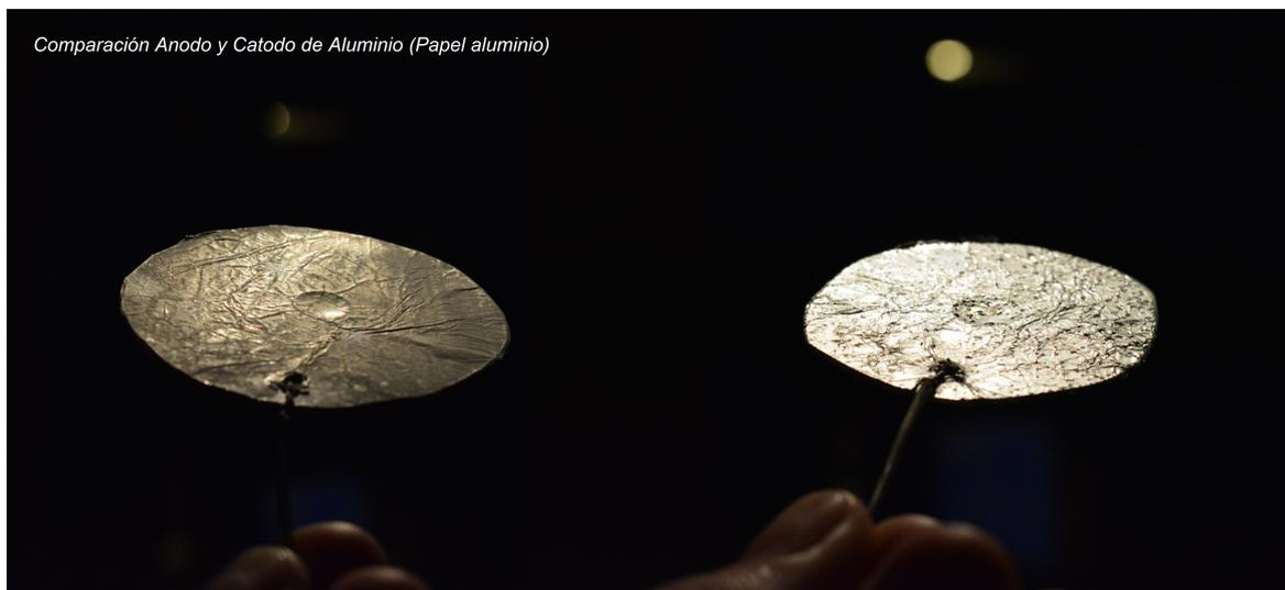
Fig. 10.30 Apariencia de los electrodos luego de dos horas de proceso
