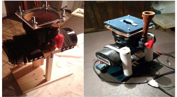
Fig. 4. Primer prototipo de celda electrolítica vs Celda electrolítica final, en vista perspectiva dorsal.
