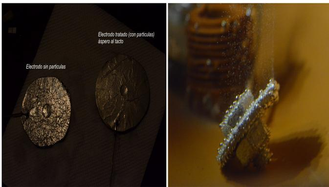
Fig. 4. Izquierda: Diferencia entre el Ánodo y el Cátodo de aluminio. Derecha:Elemento sometido al proceso de anodización.
