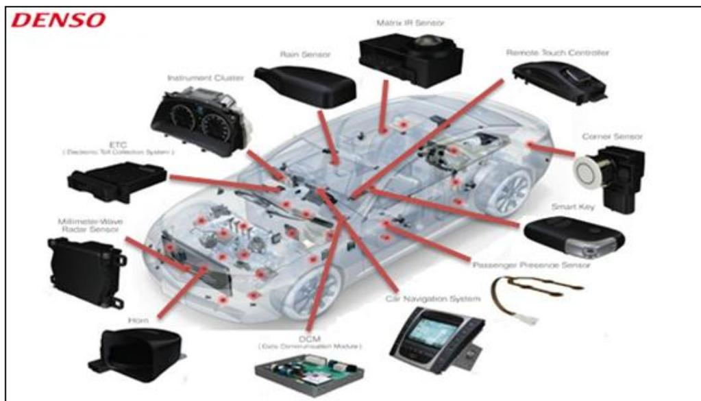
Figura 3. Componentes del sistema de Información y Seguridad
