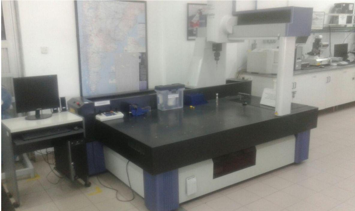
Figura 9 Máquina CMM del laboratorio. Fotografía de elaboración propia.
