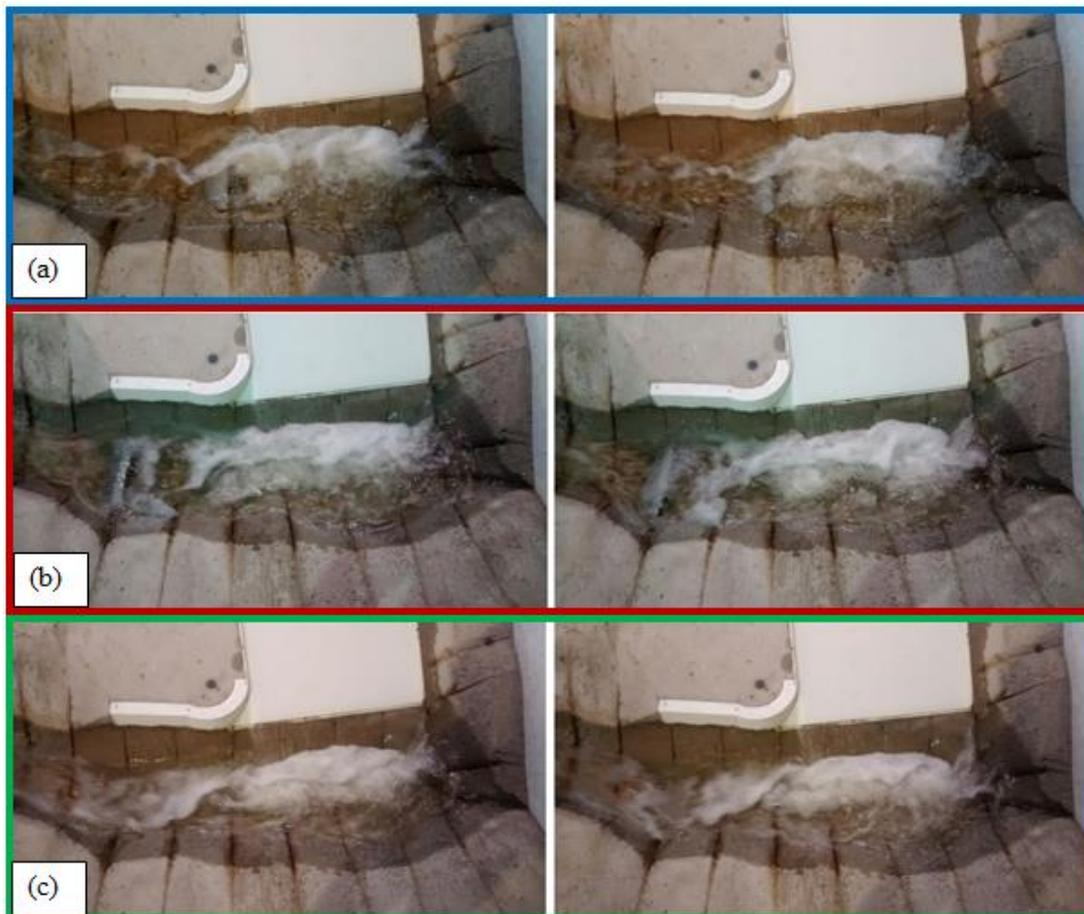
**Figura 82: Distintas condiciones (a) talud en posición A, (b) talud en posición B, (c) sin talud**
