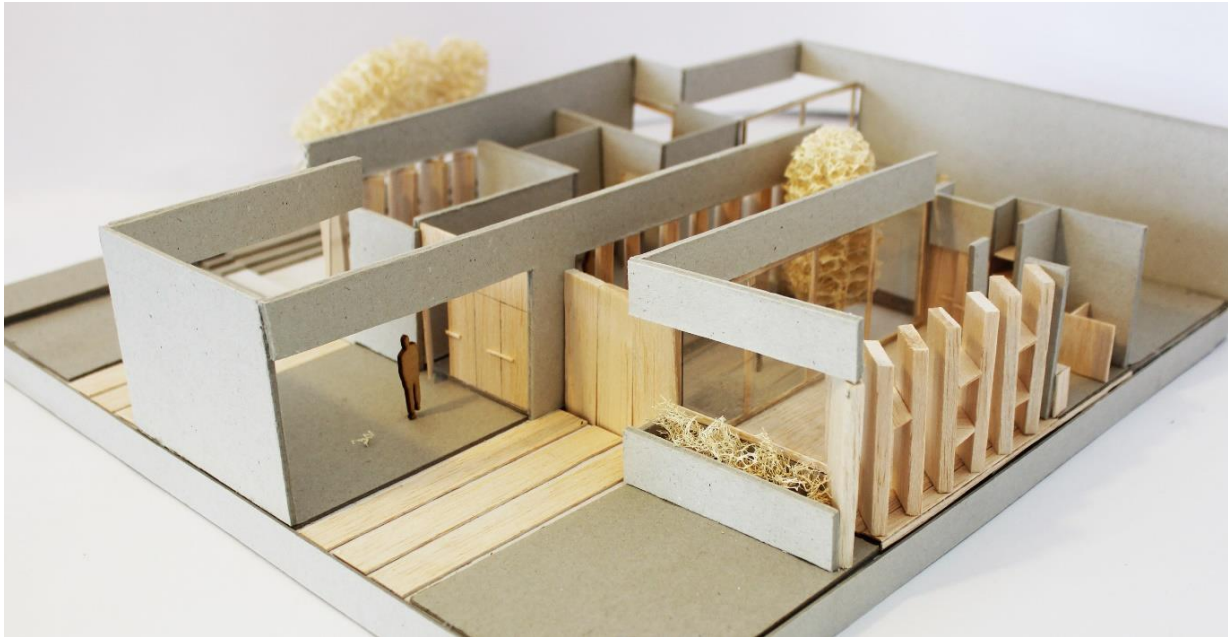
Fig. 13. Maqueta 1:50 explorando el impacto de la estructura en la configuración del espacio. Estudio del asoleamiento de las distintas envolventes, propuesta de aperturas/cierres y filtros según orientaciones
