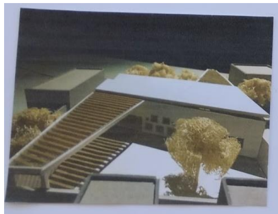
Fig. 7, 8. Estudios de asoleamiento con empleo del heliodón, en CIAL-FAUD
