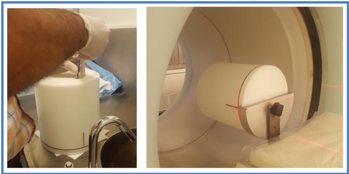
Ilustración 23: Izq: Llenado del maniquí con ^{18}\text{F} , Der: Centrado del maniquí
