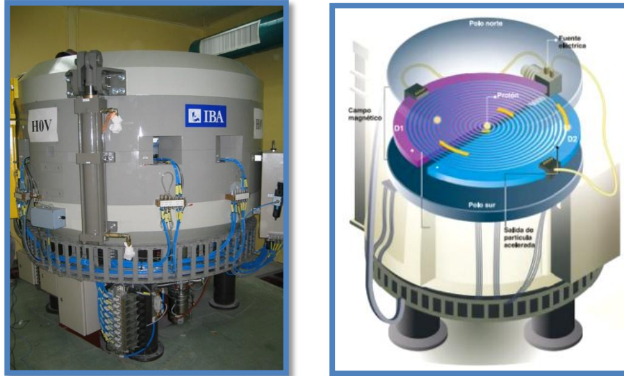
Ilustración 1: Ciclotrón: fotografía (a la izquierda), esquema (a la derecha) 1
