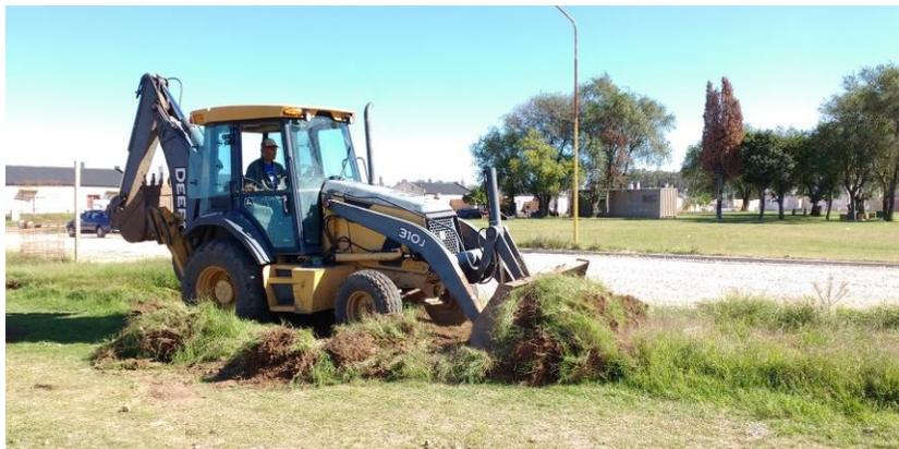
Figura 3.2.1 Pala frontal utilizada para la limpieza del terreno
