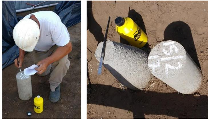
Figura 3.4.16 Desmolde y fechado de probetas
