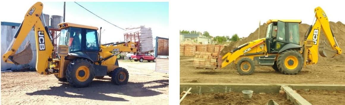
Figura 4.5.1 Transporte de materiales en pallets
