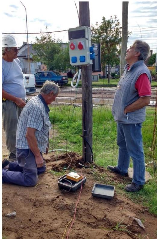
Figura 4.4.7 Verificación de la puesta a tierra
