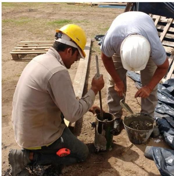
Figura 3.4.15 Llenado de probetas
