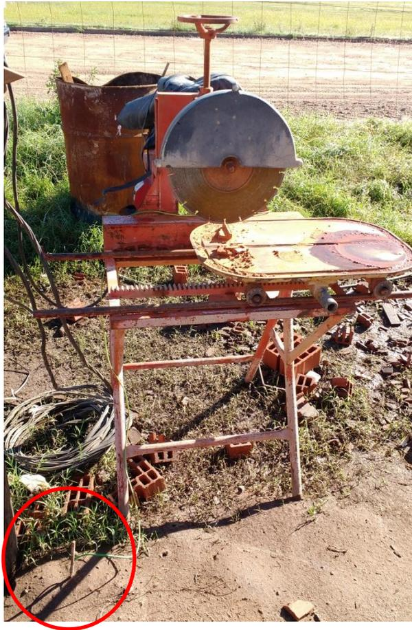
Figura 4.4.3 Puesta a tierra de maquinas
