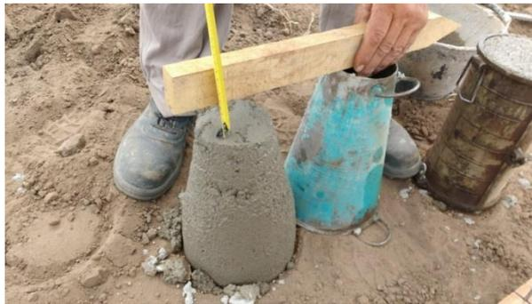
Figura 3.4.17 Ensayo de cono de Abrams
