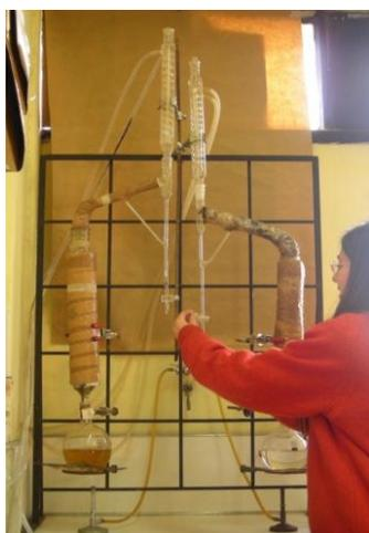
**Figura 2.3:** Destiladores tipo Clevenger utilizados para la extracción del AE de *Minthostachys verticillata* (Griseb.) Epling “peperina”.
