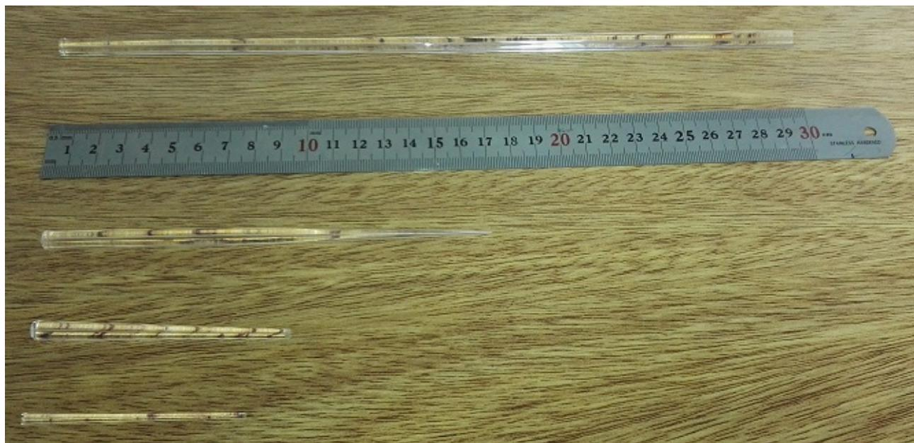
Figura 3.17: Fotografía de un tubo capilar original y de algunas lentes fabricadas en base al tubo.
