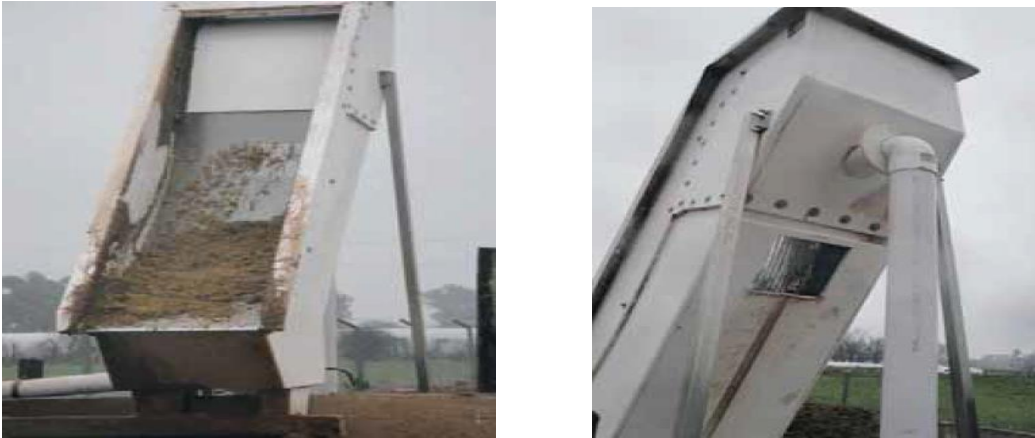
Figura 22: Ilustración de un tamiz estático, con vista superior (izq.) e inferior (der.).
