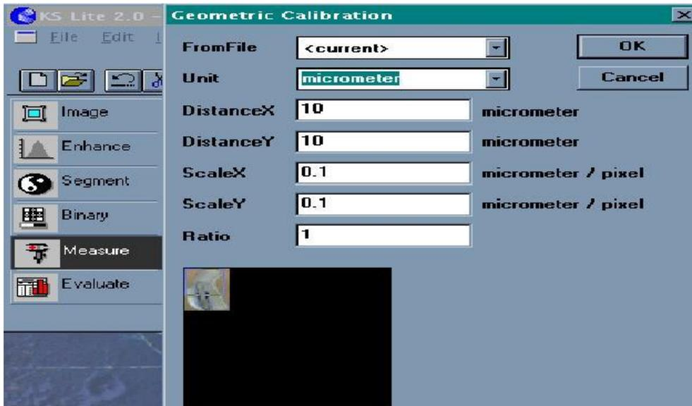
**Figura 29: Calibración Geométrica de la unidad seleccionada.**
