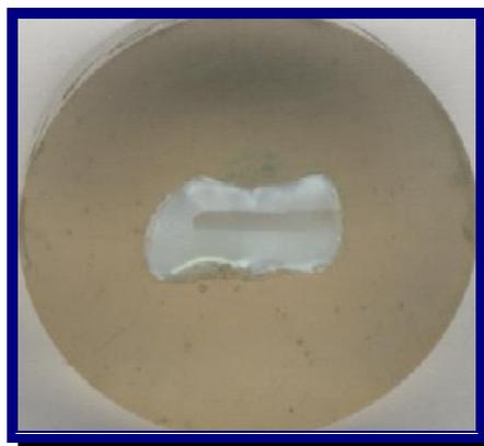
**Figura 15: Muestra de Resina Compuesta incluida en resina acrílica transparente.**
