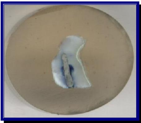
**Figura 14: Muestra de Amalgama incluida en resina acrílica transparente**
