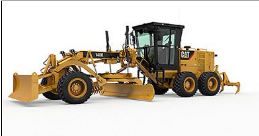
Figura 3.12- Motoniveladora CAT 140-K
