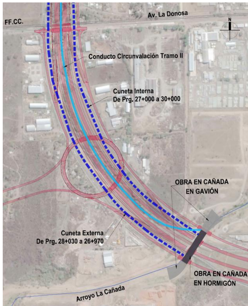
Figura 3.8: Obra de restitución de capacidad hidráulica del cruce de Ruta Nacional A019 y Arroyo La Cañada.
