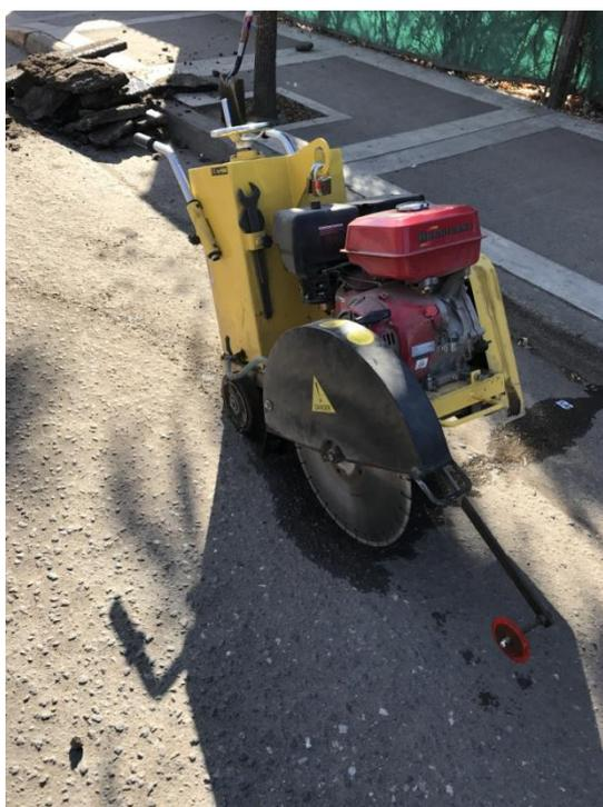
Figura 8. Aserradora de pavimento marca Honda. Fuente: Propia.
