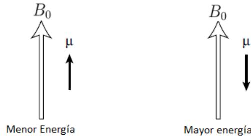
Figura 1.7: Esquema de la orientación de un momento magnético asociado a un espín 1/2 en presencia de un campo magnético externo.
