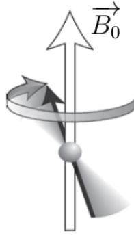
Figura 1.11: Esquema del movimiento de precesión que describe un momento magnético en presencia de un campo externo.
