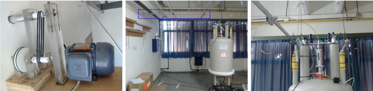
FIGURA 3.15: Motor y sistema de transmisión de rotaciones.
