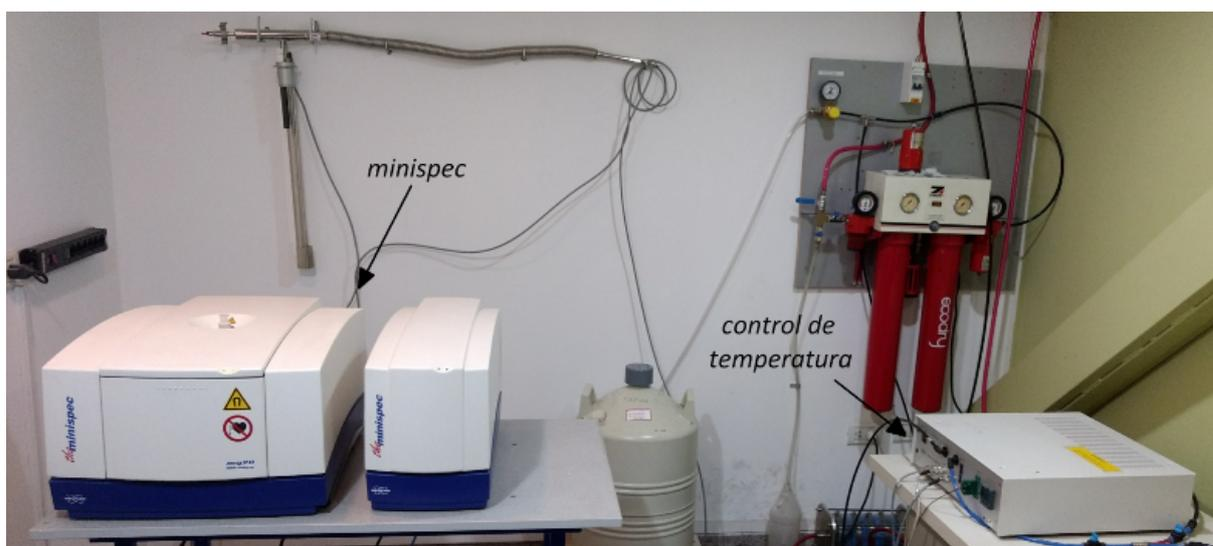
Figura 2.1: Equipo utilizado para las mediciones con RMN.
