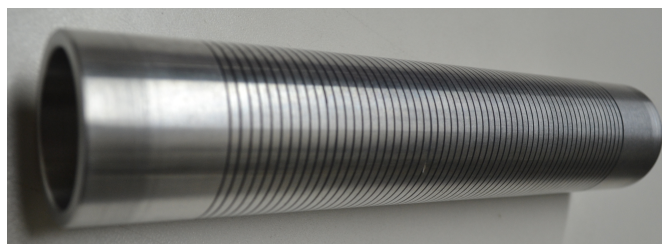
FIGURA 3.8: Capa realizada del prototipo del sistema de electroimán con conductores múltiples individuales.
