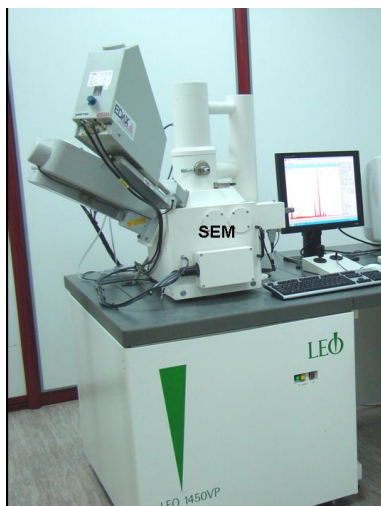
Figura 3.1: Microscopio electrónico de barrido y espectrómetros del Laboratorio de Microscopía Electrónica y Microanálisis (LABMEM) de la Universidad Nacional de San Luis.
