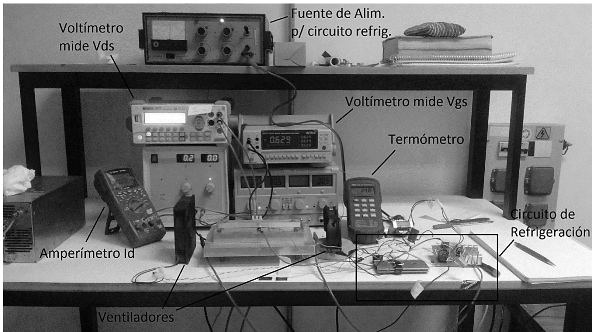
Figura 47: Montaje experimental para medir las curvas características del transistor y realizar las degradaciones a corriente I_D constante. A ambos lados del bloque se pueden observar los ventiladores. El ventilador doble se encuentra a la derecha (forzador) y a la izquierda, de forma invertida, el extractor.
