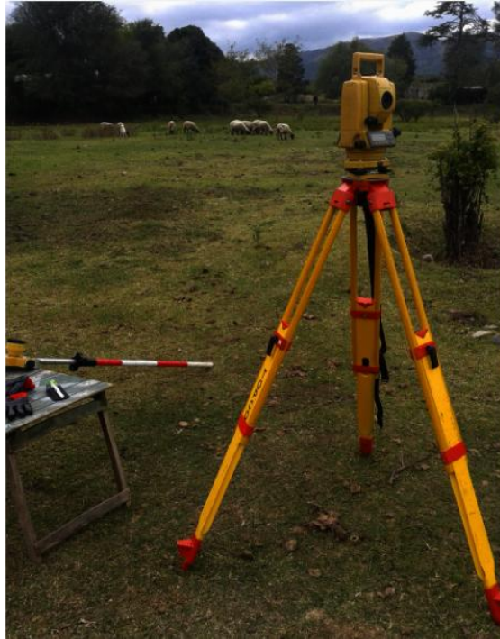
Figura 6.11: Estación total en la estación A del polígono geométrico de apoyo.
