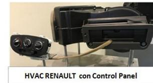
Están compuestas, entre otras partes, por el evaporador, masa radiante, motor forzador de aire, válvula de expansión, termostato y resistor. Cuentan con un sistema de compartimentos y canales internos que permiten direccionar el aire de acuerdo a los comandos manuales o automáticos presentes en el tablero del automóvil.
